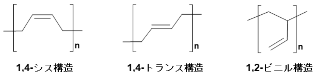
図 3.1 ポリブタジエン (PBD) の幾何異性体の構造式
