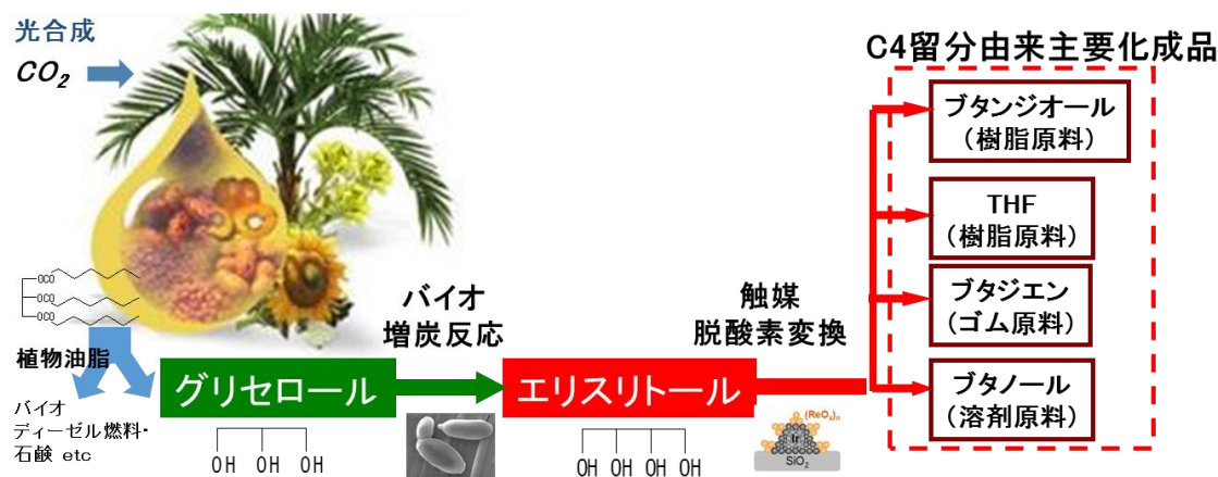
図 4.1 バイオ技術と触媒技術を融合した C4 化成品新規製造プロセス
