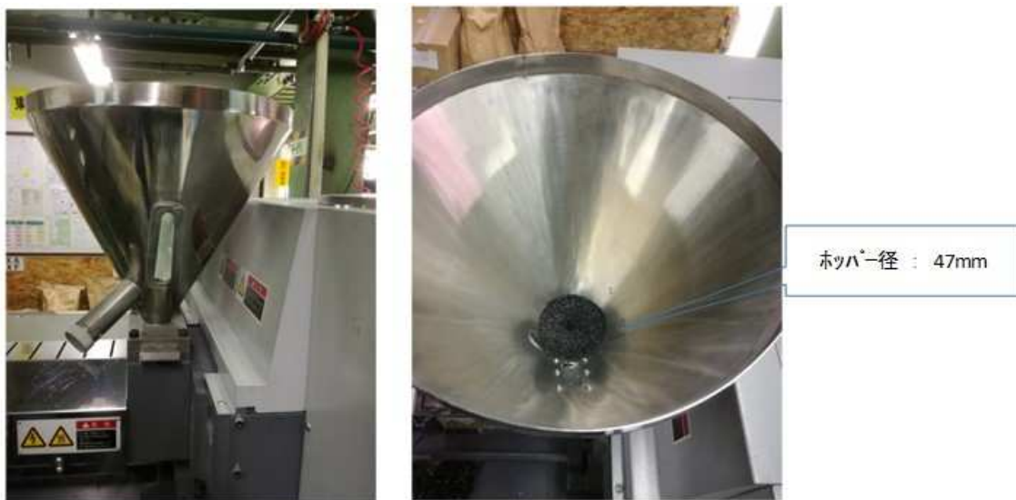
図 2.7.3.2.4 成形機材料投入口(ホッパー)
