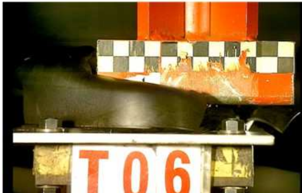
図 2.6.7 各試験体の破壊状況(パルプ添加有り)
