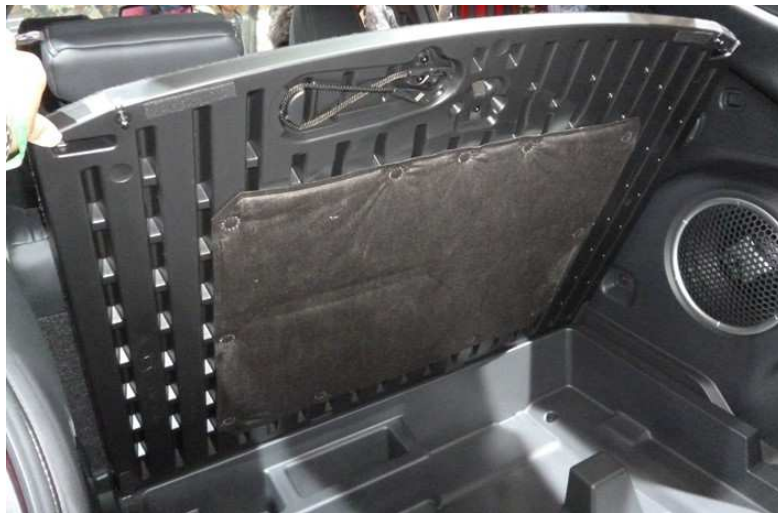
図 3.2.1.1 PP 樹脂による自動車樹脂部品（ベースライン）例
