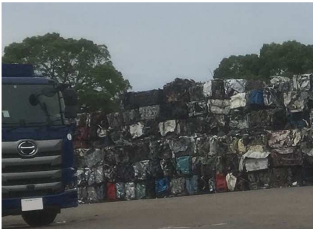
図 4.1.1.1.3 廃車ガラをプレスした廃車ブロック
