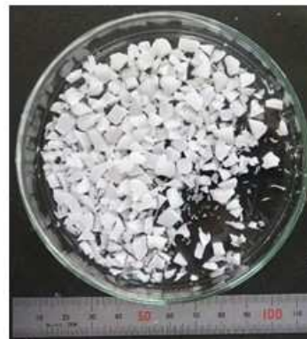
図 2.7.3.2.2 粉砕物の形状 (PE)
