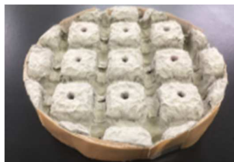
図 3.1.1.1 パルプ繊維による自動車吸音材
