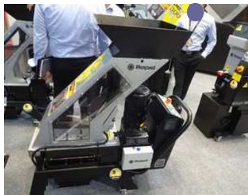
図 4. 1. 2. 3. 2 小型破砕設備の例
