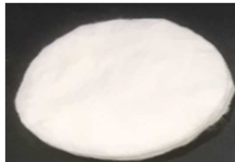
図 3.1.1.2 不織布（ポリエステル繊維）による自動車吸音材
