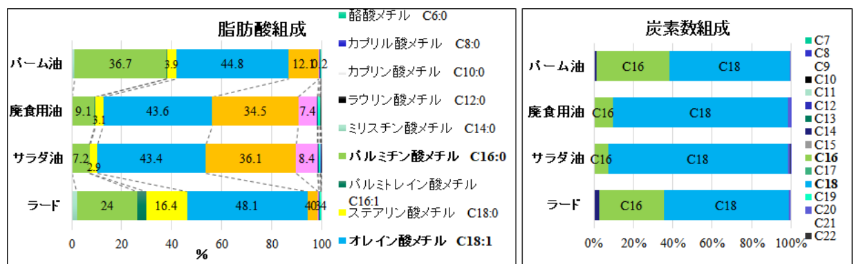
図 36 各種油種の脂肪酸組成及び炭素数組成 (過去の調査データによる)
