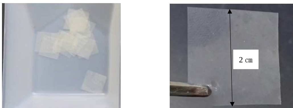
図 73 高温汚泥 2 を用いた PHBH 単独フィルム分解の様子 (左 8 日目、右 20 日目)
