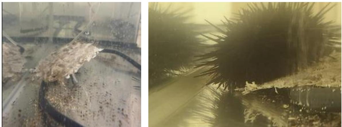
図 5-2 水槽内に投入した板状 MaterBi(左)と板状 MaterBi を食べるウニの様子(右)
