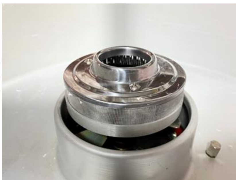
図 2-1 澱粉ポリエステル樹脂の繊維化に用いた綿飴機の回転部
