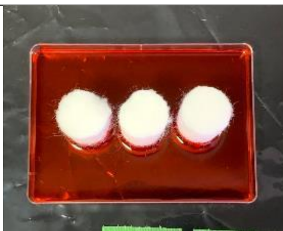
図 2-18 乾燥したウレタン、ロックウール、酢酸セルロース、MaterBi、PLA レーヨン 培地を着色した水に浸けて吸水させ、培地の吸水性を評価した。図は 19 時間後の吸水 状況を示す。
