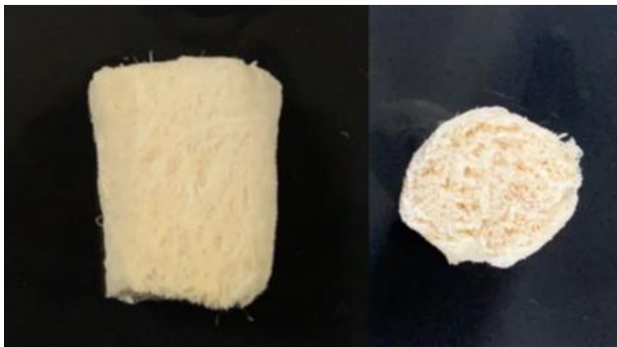
図 2-7 繊維化した MaterBi を筒状に束ね、側面をヒートガンで固めた培地
