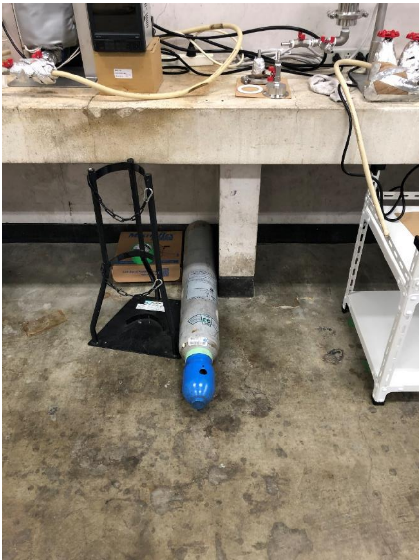
写真 13. 窒素ボンベ：反応中及び生成後の酸素遮断に用いる。
