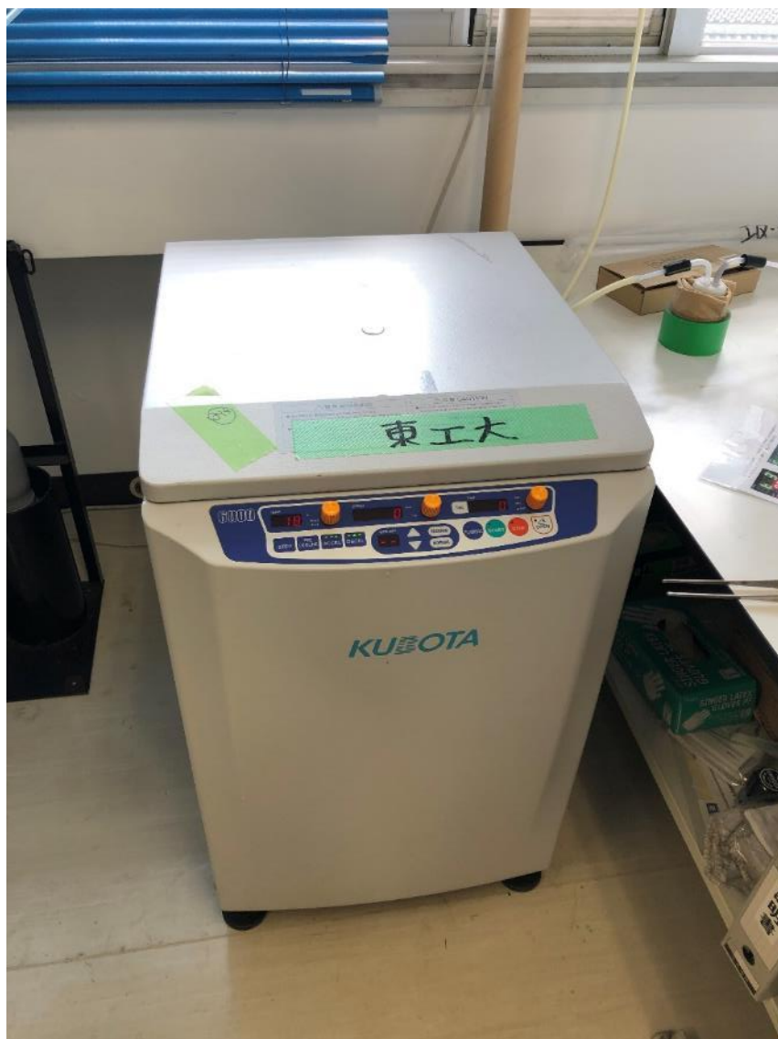
写真 10. 高速遠心機：500ml テフロンボトル×6 本での遠心が可能となった。
