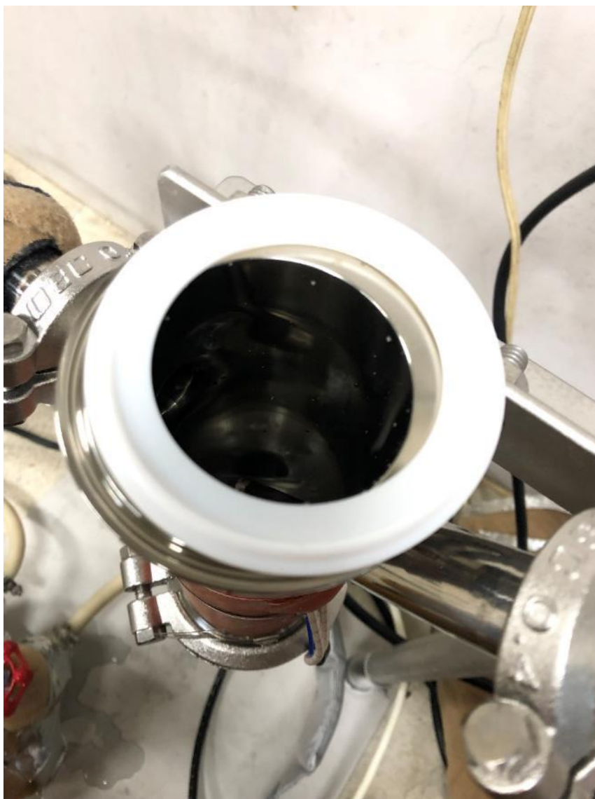
写真3 本体上部より見たリアクター内部：空洞部に触媒ペレットを装填する。
