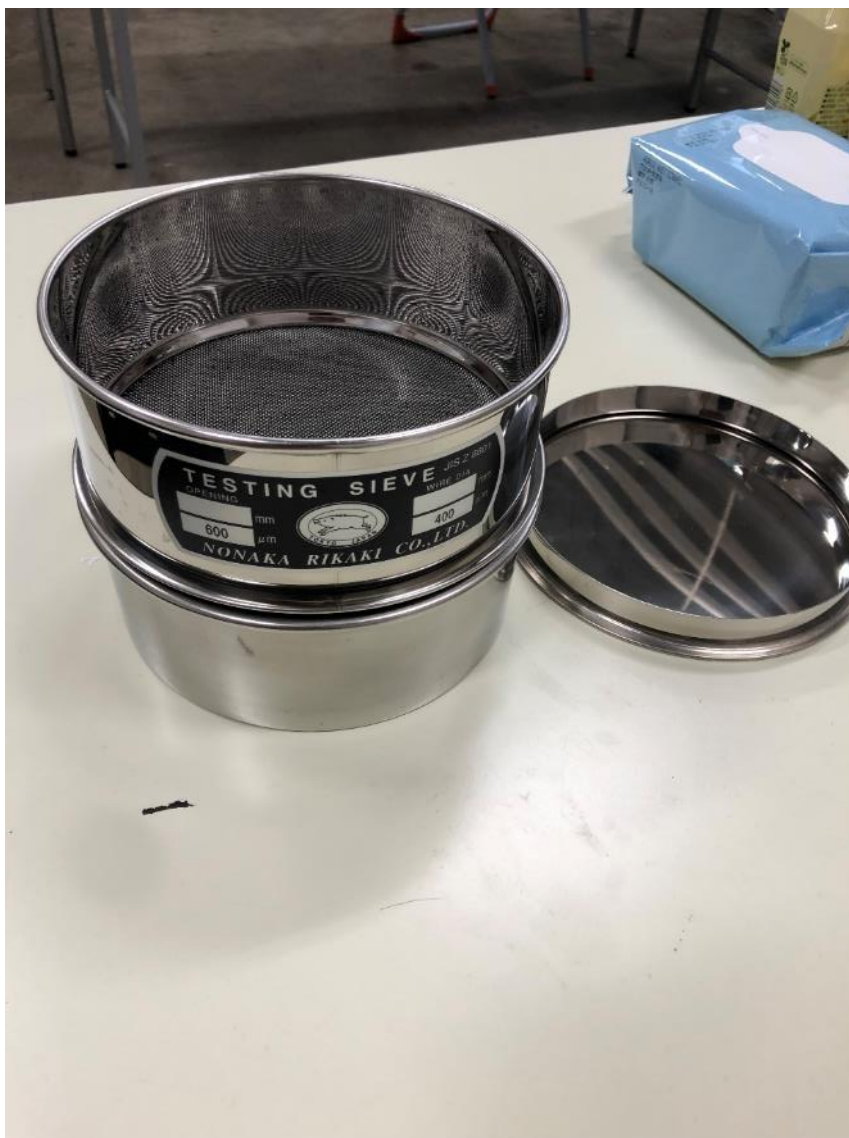
写真 18. 活性炭用の JIS 篩：リアクターの吸着筒に充填する前に粒度を選別する事で、吸着筒からの流出を防止する。
