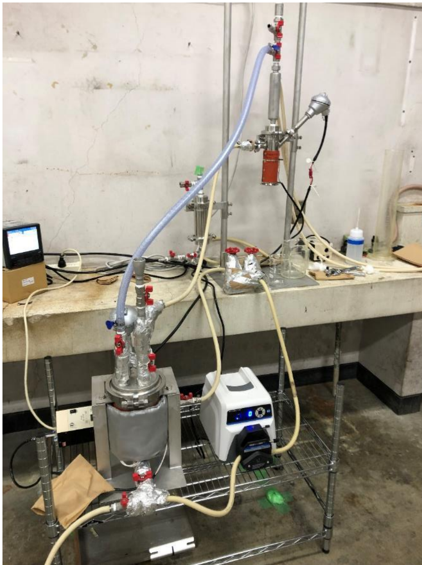
写真 40. 均圧チューブ取り付け：原料槽内とリアクター内の気体圧力を均一にし、圧力が高まっても液体が流動できるようにしている。
