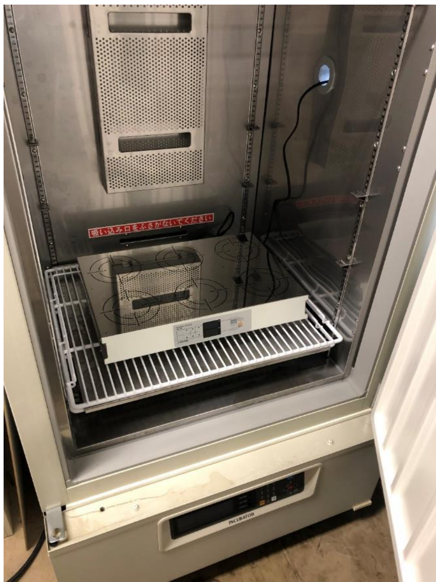
写真 7. 触媒製造用の 400L 大型恒温槽（槽内スケール）
