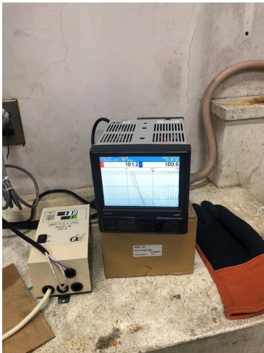
写真 32. 温度モニター：原料槽内（左側）とリアクター内（右側）の温度管理用。画面は沸点を超えたことを示している。
