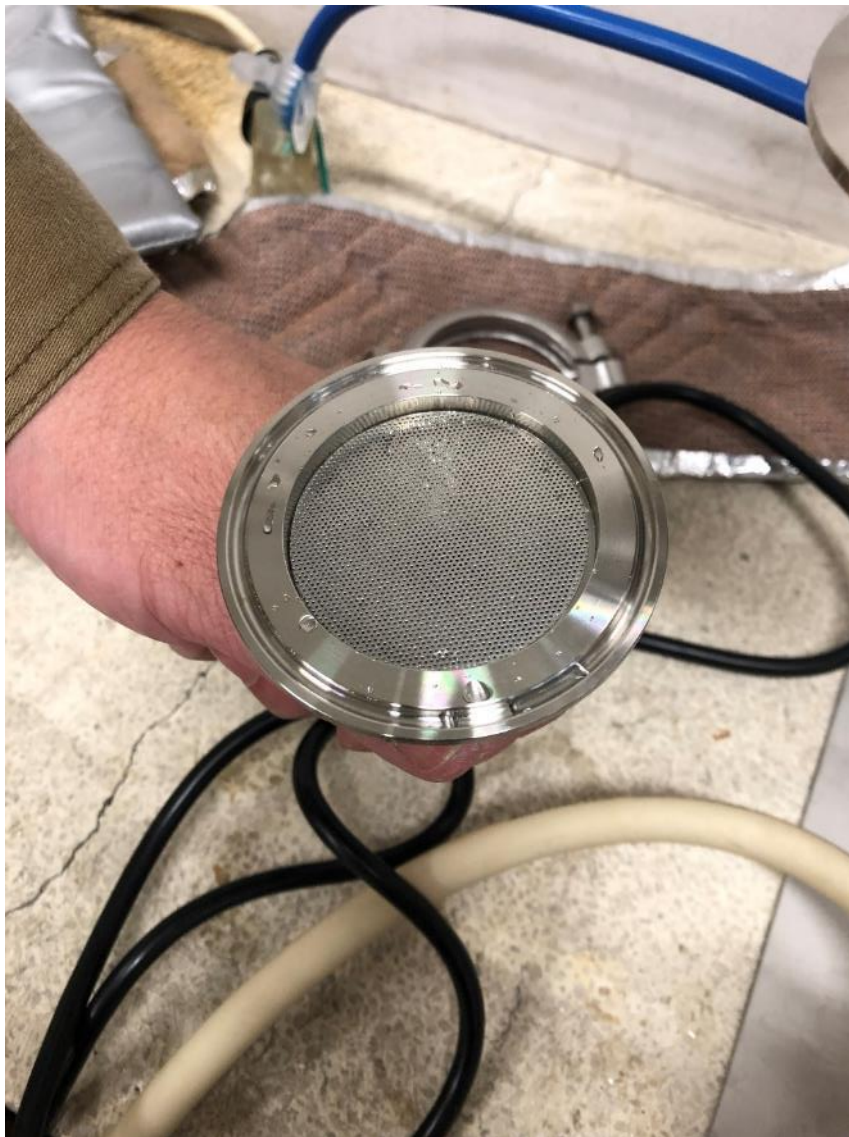
写真 4. リアクター 下部フィルター：リアクター内の「触媒ペレット」がリアクター外に漏れるのを防ぐ。
