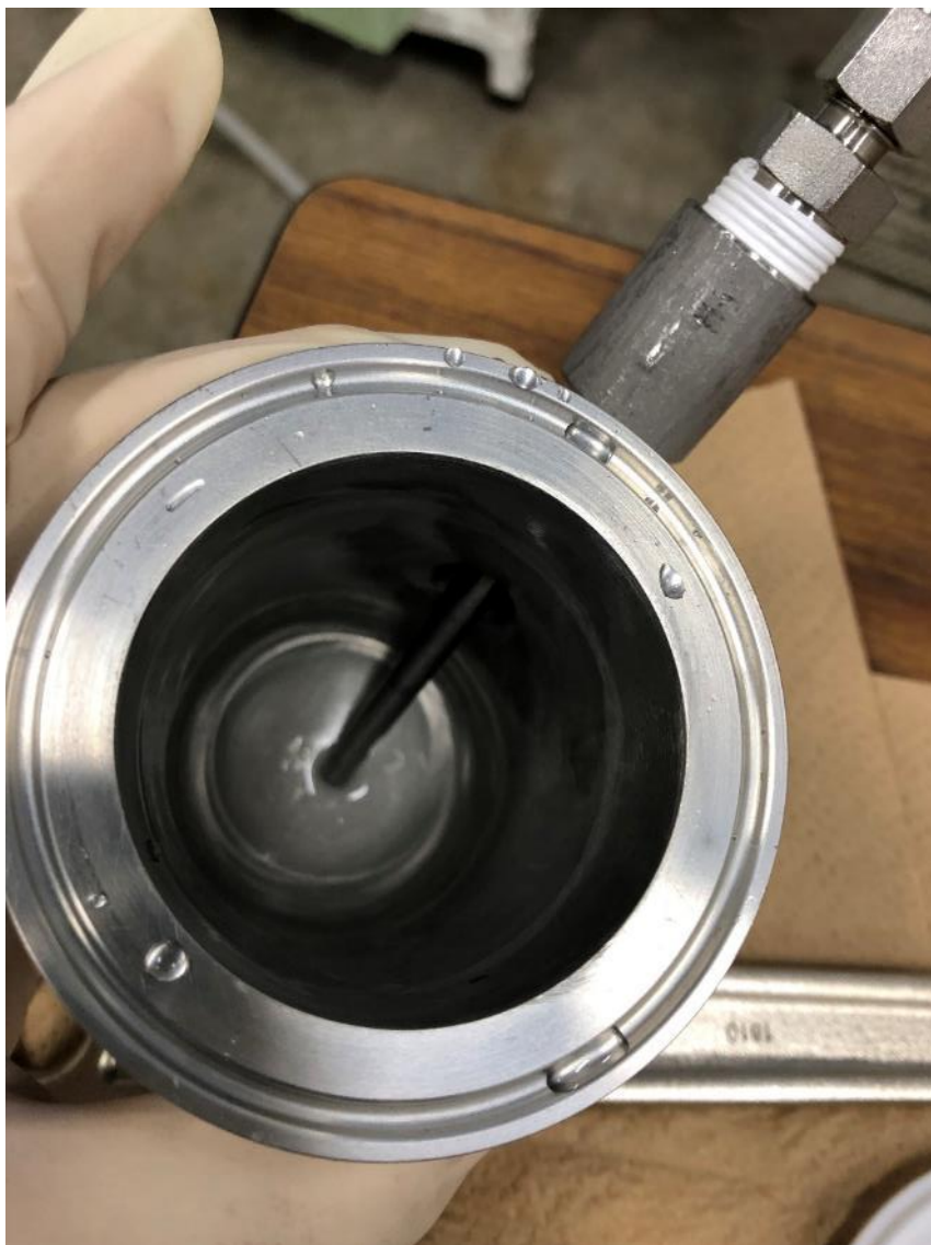
写真 34. ペレット一部が溶出
