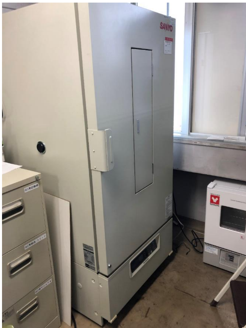
写真 8. 触媒製造用の 400L 大型恒温（外観）
