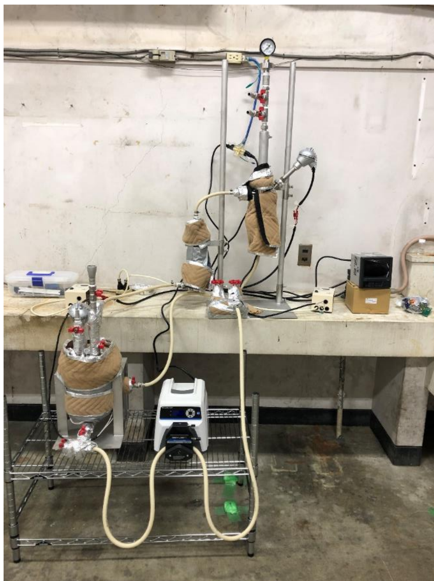
写真 5. 300ml リアクター 全景：左下「原料槽」から「ポンプ」経由で右上「リアクター」で触媒反応が促進され、その後、中央の「吸着筒」を経て「原料槽」に戻る循環となる。
