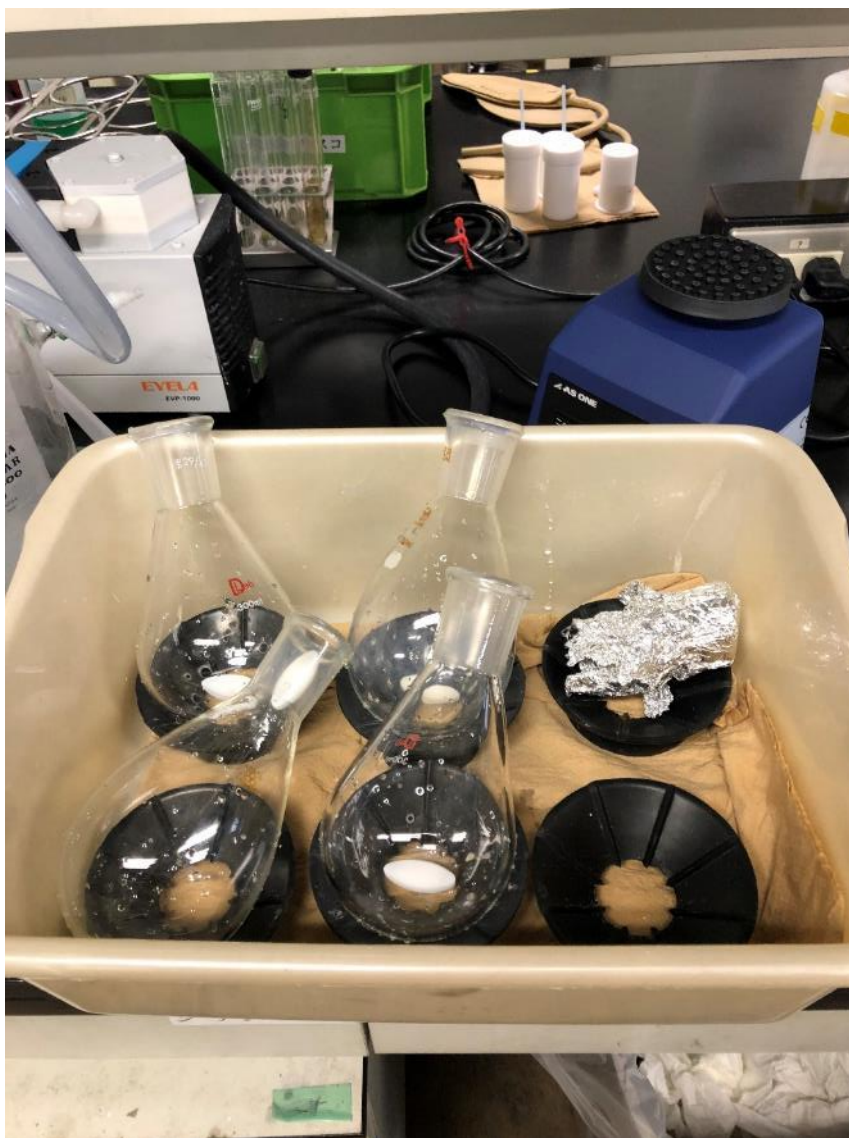
写真 11. ナスフラスコ（300ml）とフラスコレシーブ：従来法となる 100g/週スケールでの触媒製造。
