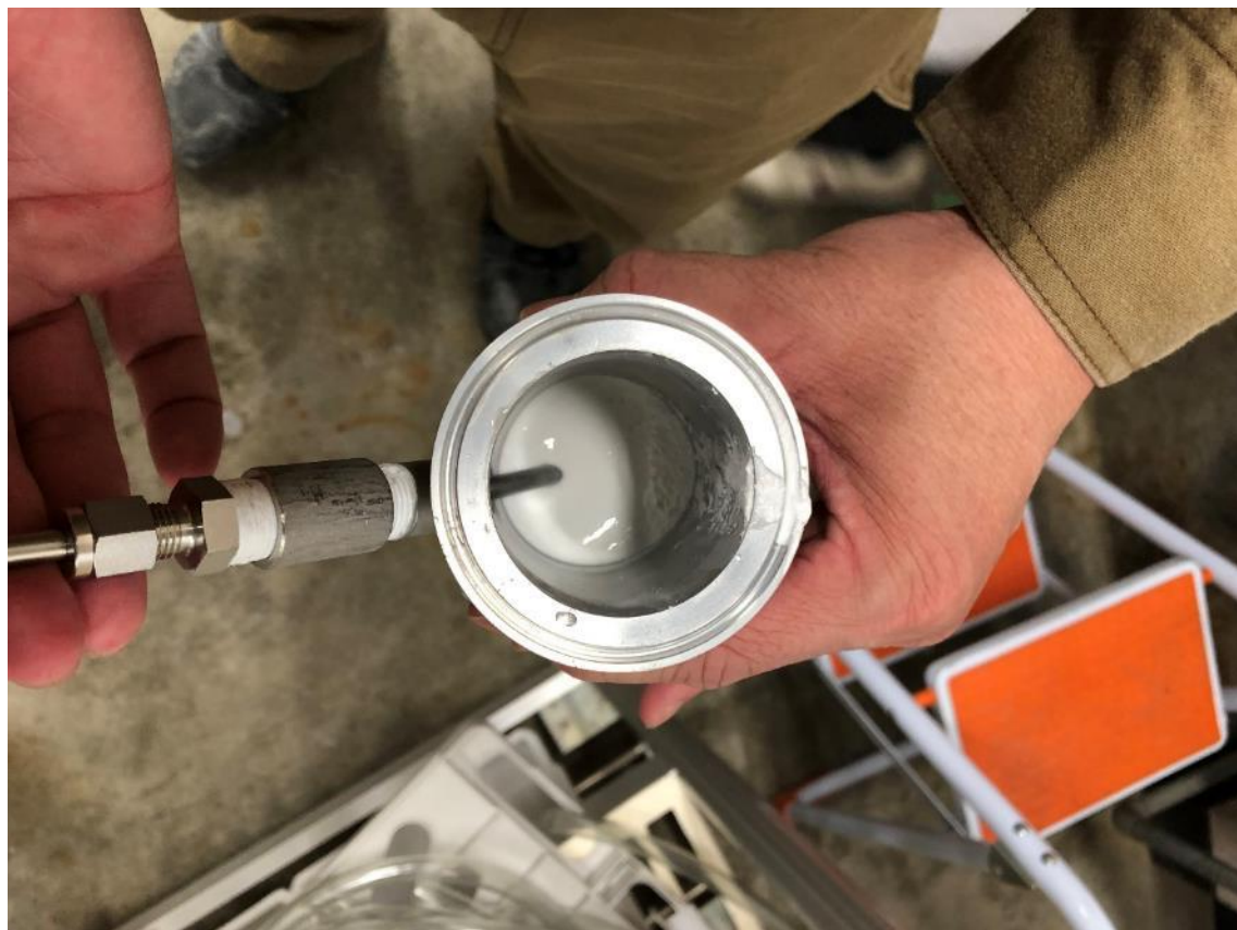
写真 26. リアクター内の粉体触媒：乳液状となっている。
