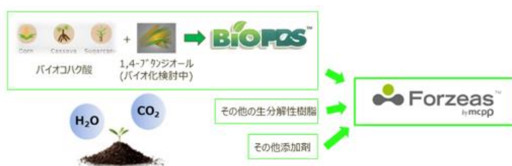
図 4-36. BioPBS と FORZEAS の製造フロー（三菱ケミカル）
