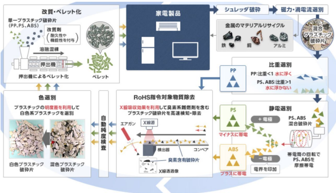
図 3-14 三菱電機の家電リサイクル（再生樹脂原料製造のフロー）
