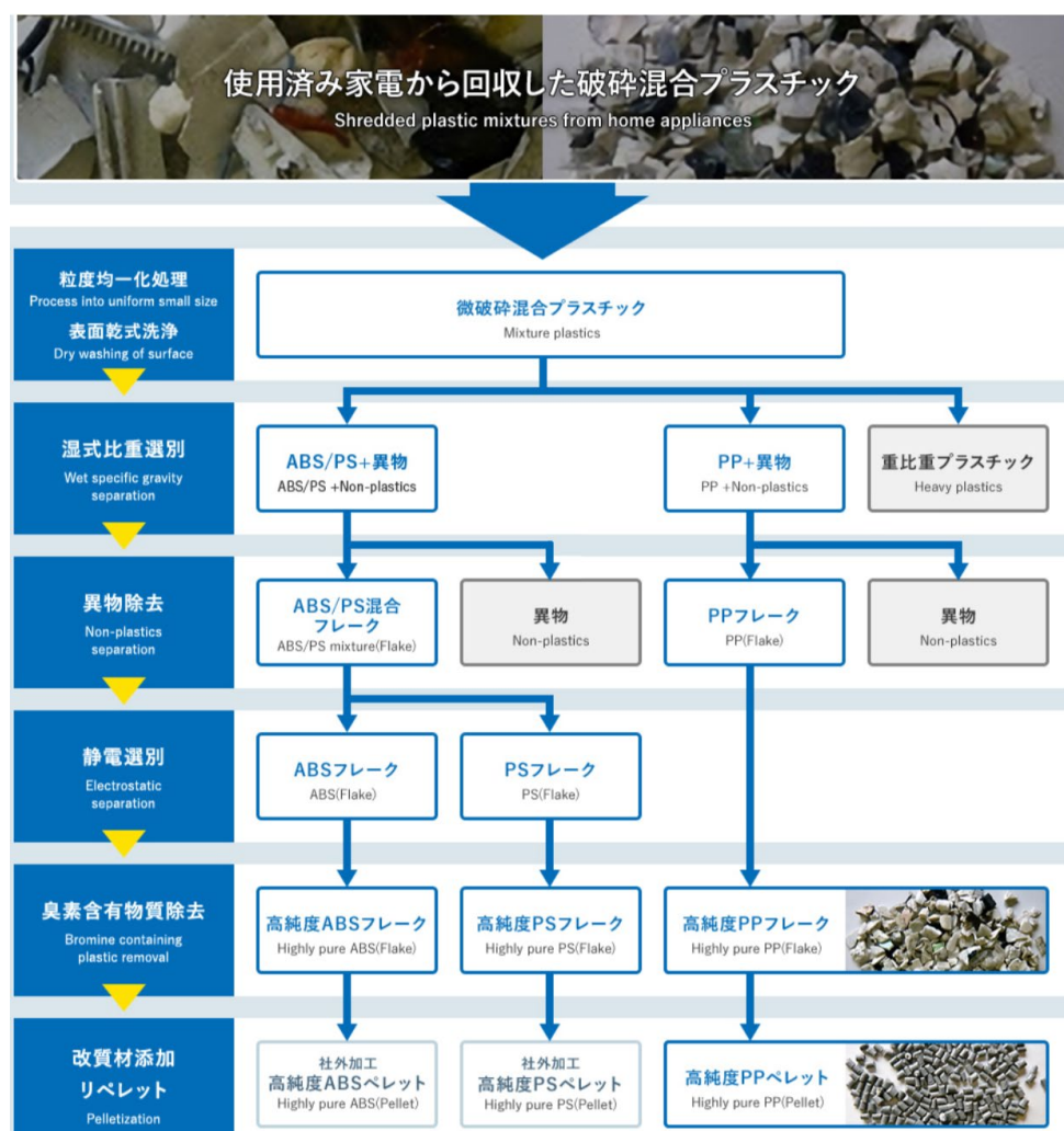
図 3-20 三菱電機の再生 ABS 樹脂生産フロー
