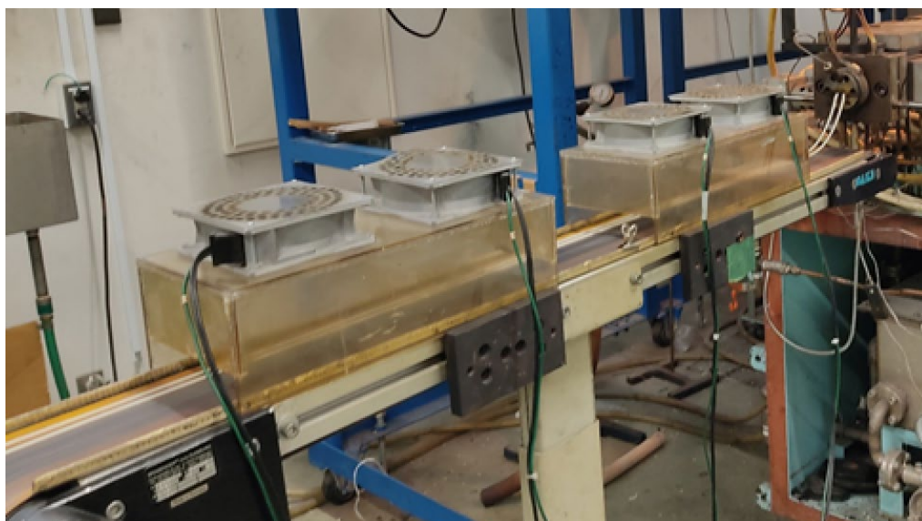
図 2-34 冷却装置（空冷コンベア）
