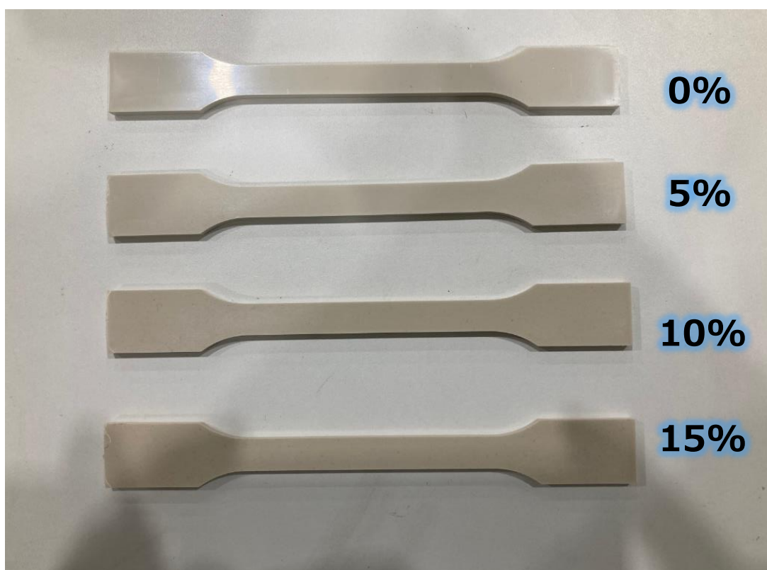
図 2-48 手解体由来 再生材 PS(CeF0%、5%、10%、15%)試験片
