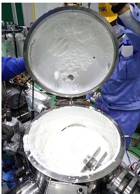
図 2-18 混合後のタンク内の状態
