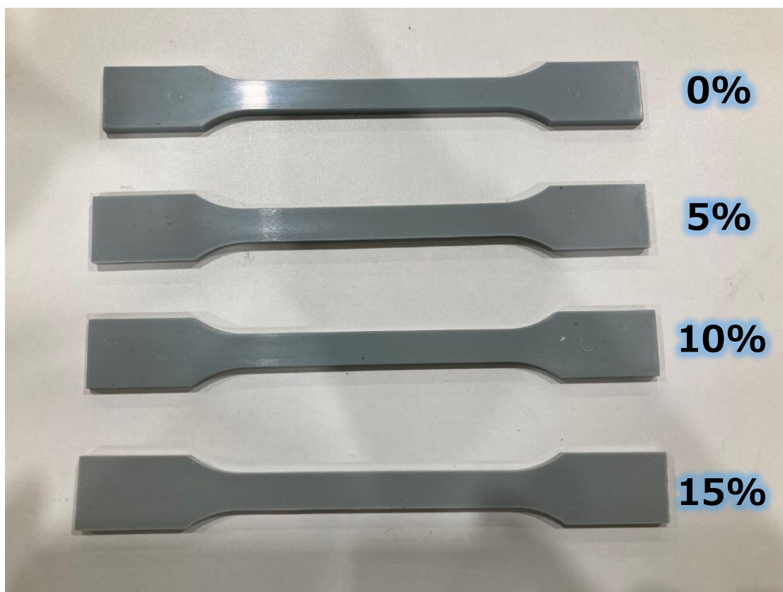
図 2-46 機械破碎由来 再生材 PP(CeF0%、5%、10%、15%)試験片
