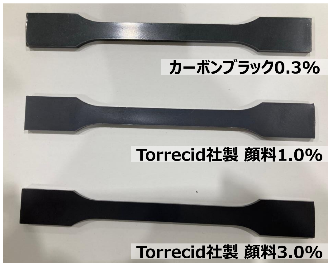
図 2-51 黒色顔料を用いた判別評価用試験片
