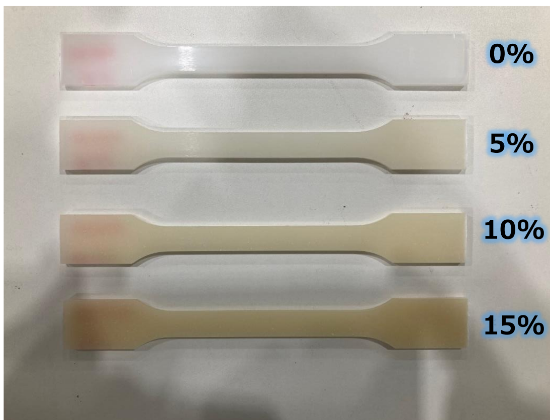
図 2-44 バージン材 PP(CeF0%、5%、10%、15%)試験片
