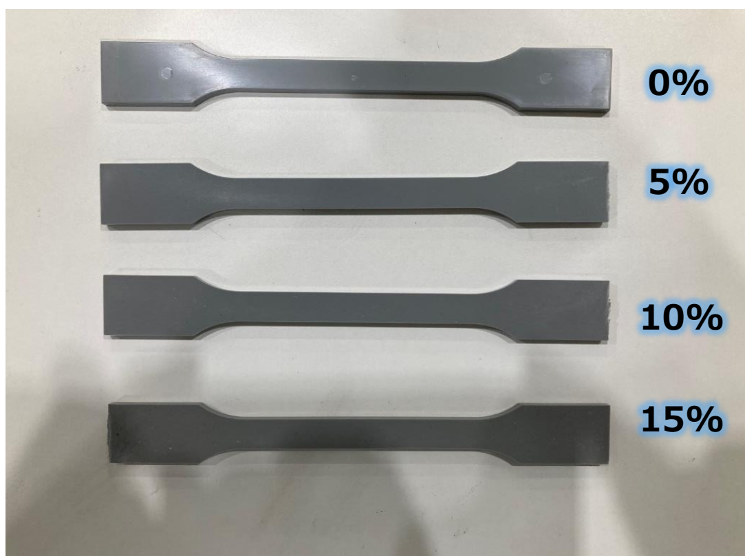
図 2-49 機械破碎由来 再生材 PS(CeF0%、5%、10%、15%)試験片
