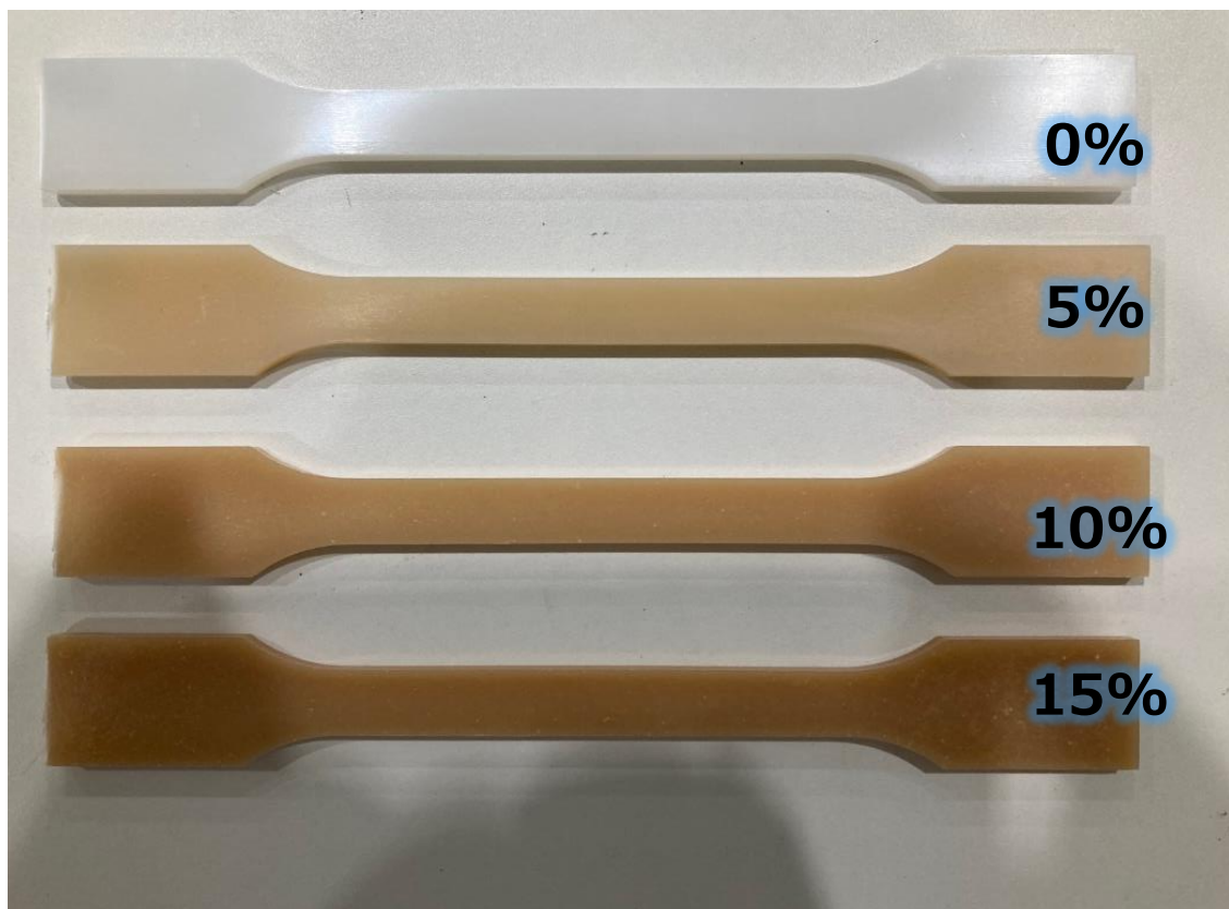
図 2-47 バージン材 PS(CeF0%、5%、10%、15%)試験片
