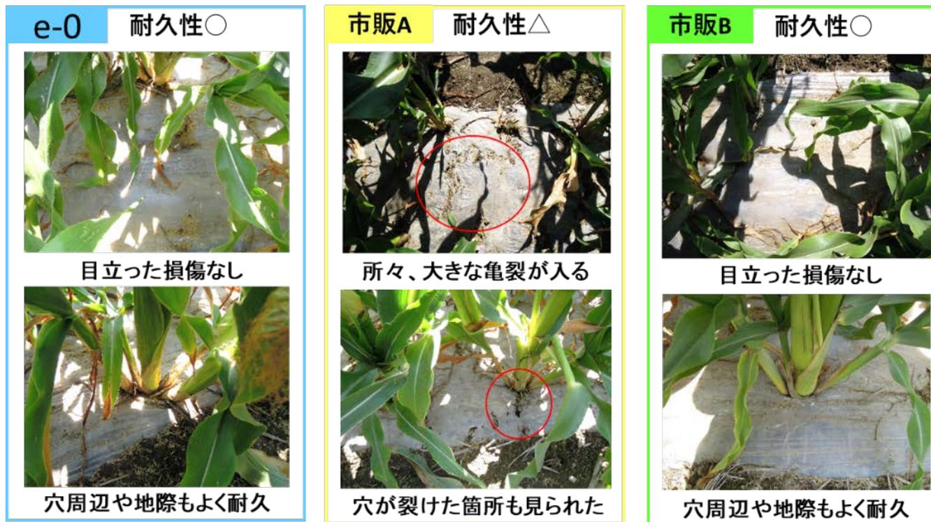
第 63 図 促成作スイートコーン栽培終了時における各フィルムの崩壊程度
