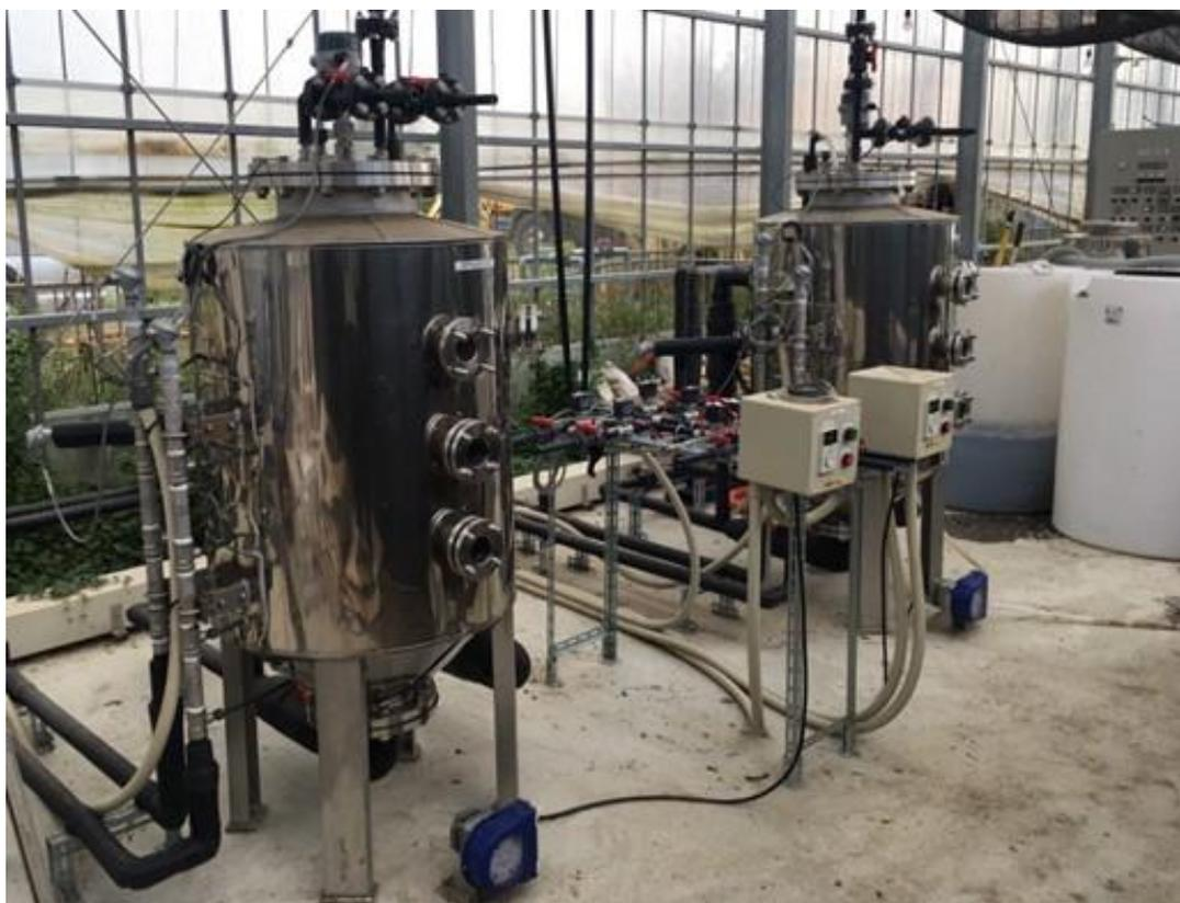
図 4-6 メタン発酵槽（前方）
