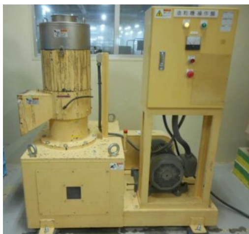
図 2-1-1-3 ディスクペレッター（左）とその処理概要（右）
