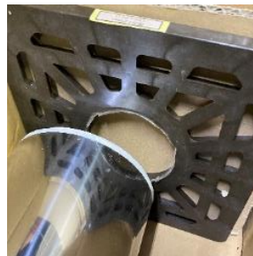
図 2-5-1-7 落下試験後のサイドプロテクターの状態
