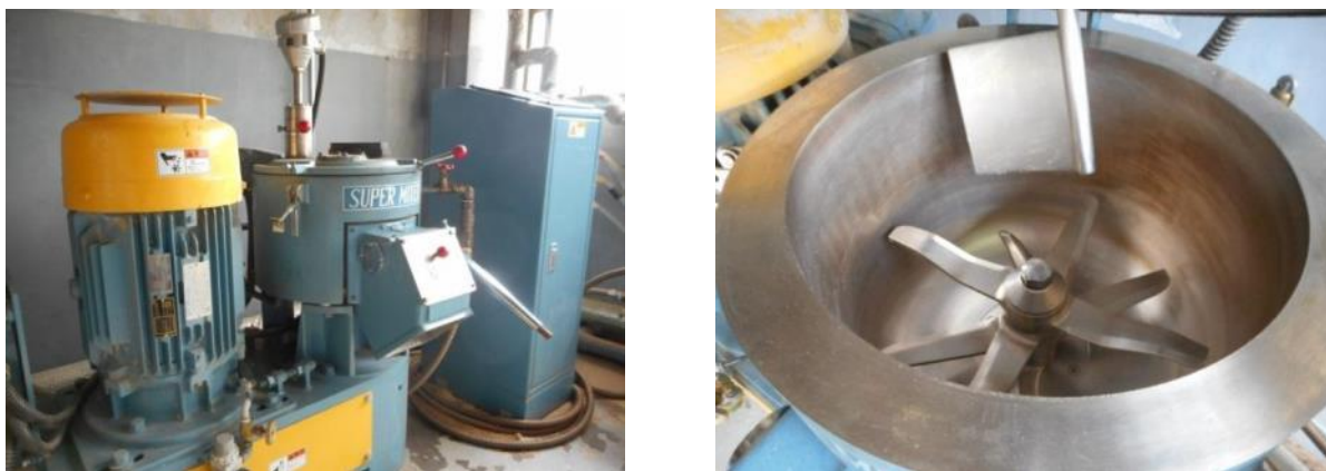
図 2-3-1-5 高温高速攪拌ミキサーの写真
