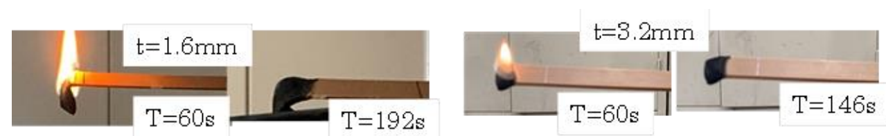
図 2-2-1-6 水平燃焼試験(DC-FR81)
