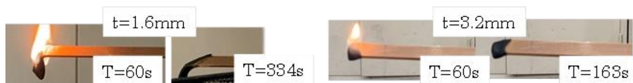
図 2-2-1-5 水平燃焼試験(DC-FR80)
