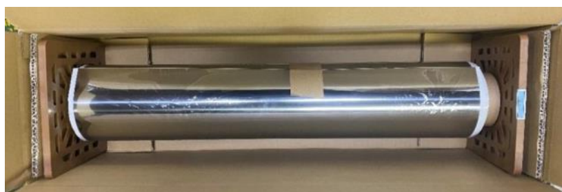
図 2-5-1-5 落下試験 梱包方法
