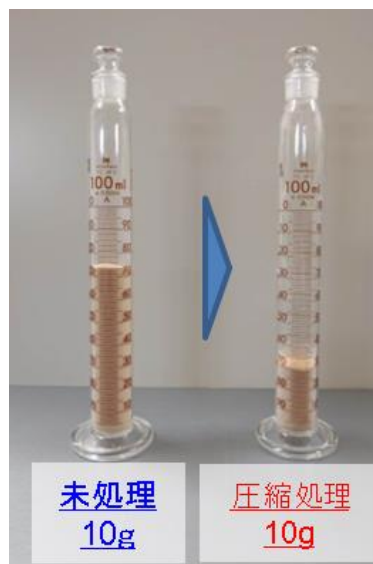
図 2-1-1-5 圧縮処理による嵩比重変化 (左) と圧縮前後での嵩比較写真(右)
