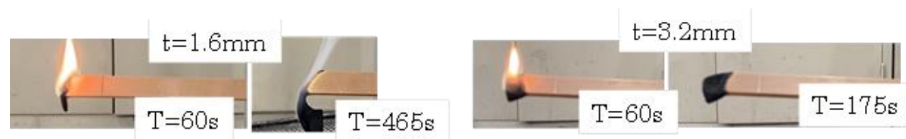
図 2-2-1-7 水平燃焼試験(DC-FR82)
