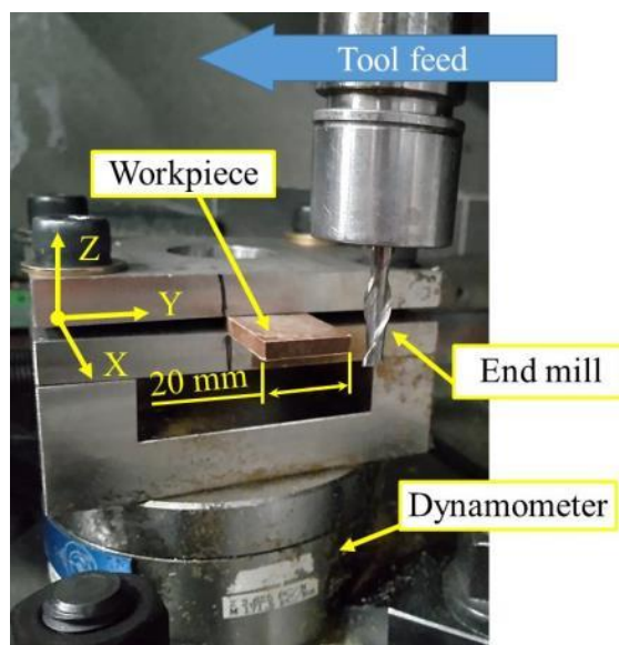
図 2-2-1-25 切削実験の概要
