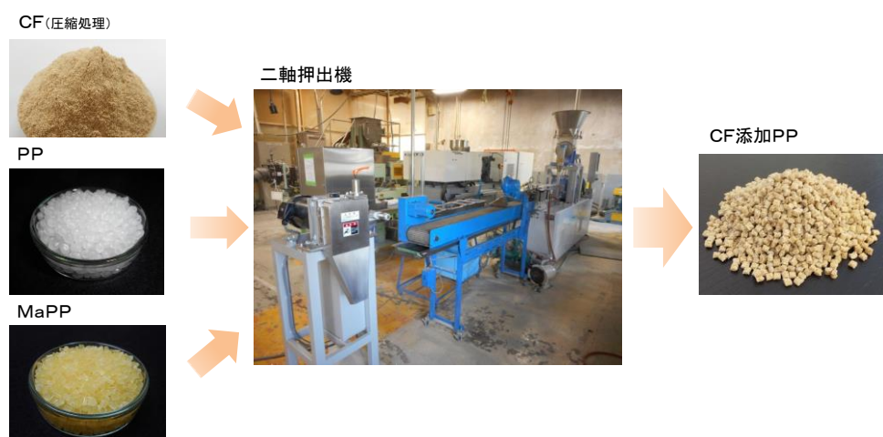
図 2-1-1-4 CF 添加 PP 作製の概要とサンプル例
