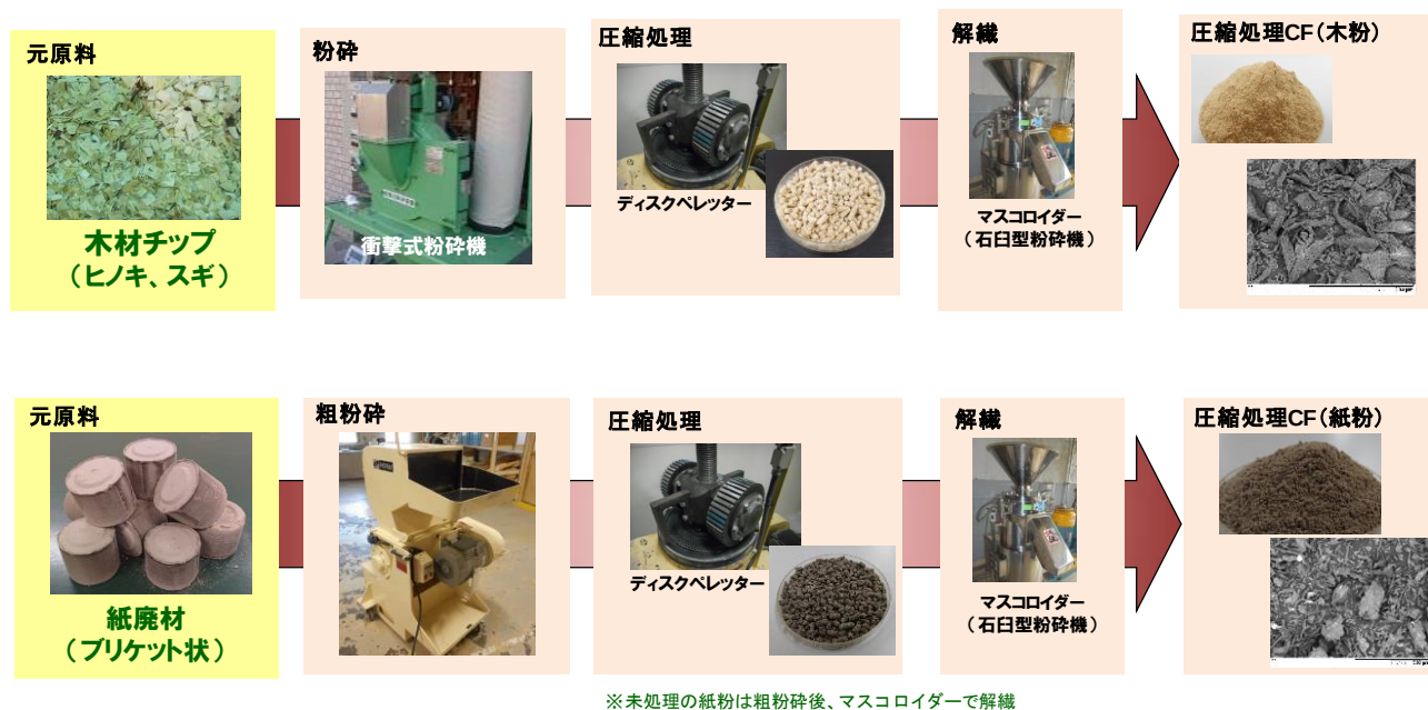
図 2-1-1-2 圧縮処理 CF の概要図
