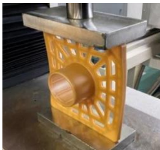
図 2-5-1-3 圧縮試験時の様子
