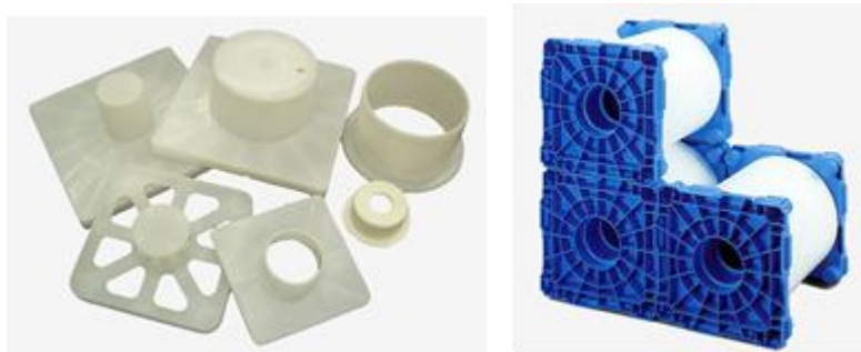
図 2-5-1-1 サイドプロテクター 高機能フィルムや医薬包装、食品用フィルムの 側面保護や中吊り（宙吊り）梱包で使用される。
