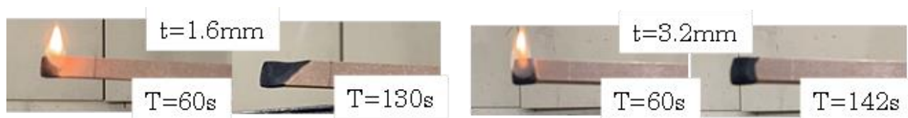
図 2-2-1-4 水平燃焼試験(DC-FR79)
