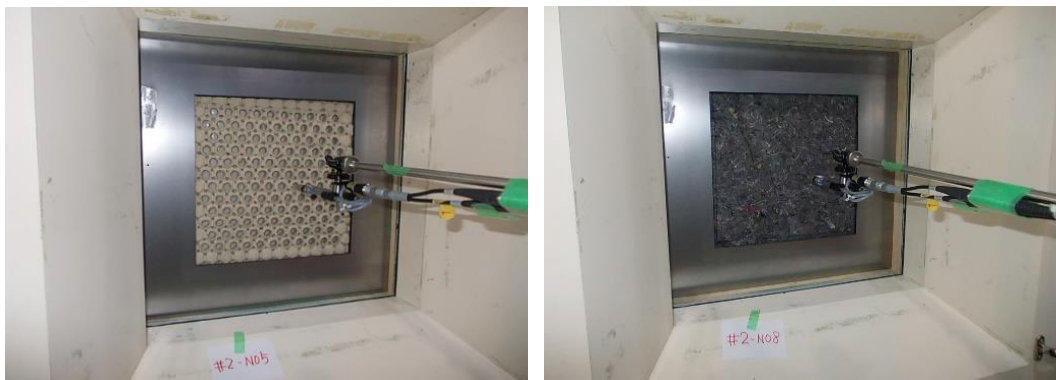
図 1.1.2.2.1 遮音性試験の状況
