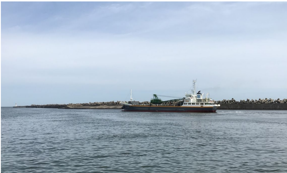
写真-3.3 ガット船による浚渫土砂の運搬状況
