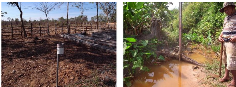
図30 カンボジア王国への渡航時に再設定した雨量計（左）と水位観測のための標尺（右）
