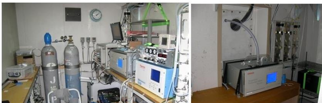
図4. 連続測定装置の写真（左：オゾン、一酸化炭素；右：ブラックカーボン）
