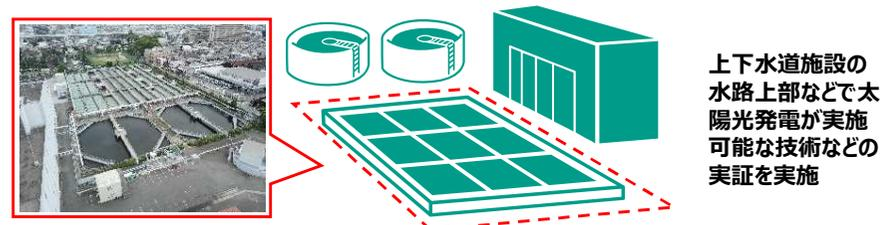
上下水道施設の水路上部などで太陽光発電が実施可能な技術などの実証を実施
