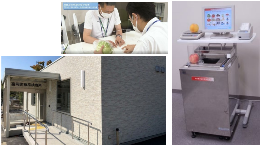
図 II-4 富岡町食品検査所（食品検査の様子）及びスクリーニング用の NaI スペクトロメータ
