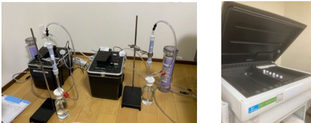
図8 RAD7とRADH2O (左) と液体シンチレーションカウンタ (右) を用いた飲料水中のラドン濃度測定の様子
