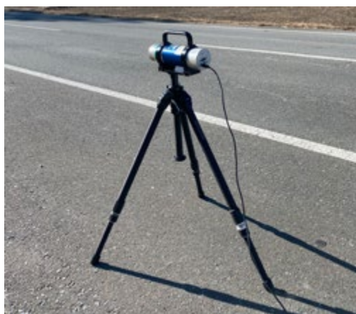
図1 \gamma 線波高分布の測定の様子
