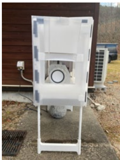
図2 ハイボリュームエアサンプラを用いたサンプリングの様子（左）と高純度 Ge 半導体検出器による大気浮遊塵の測定の様子（右）
