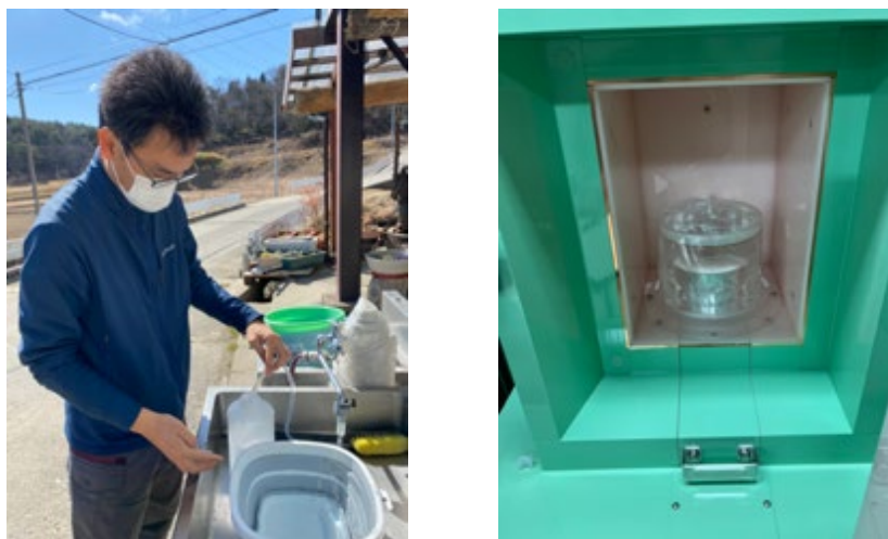
図7 飲料水の採水の様子（左）と高純度Ge半導体検出器によるマリネリ容器での測定の様子（右）
