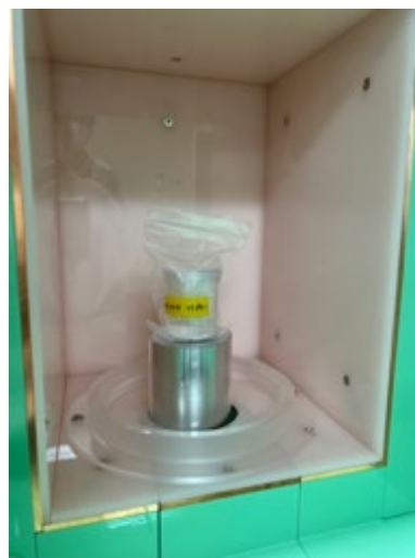
図2 ハイボリュームエアサンプラを用いたサンプリングの様子（左）と高純度 Ge 半導体検出器による大気浮遊塵の測定の様子（右）
