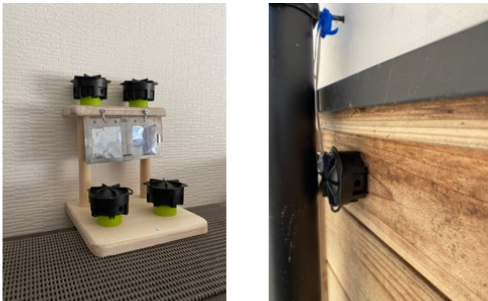
図 4 家屋内での RADUET とトロン子孫核種モニタの設置の様子 (左) と屋外でのラドン濃度の測定の様子 (右)
