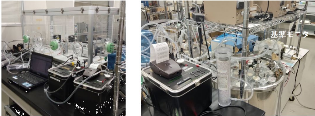
図6 ラドン較正場（左）とトロン較正場（右）でのRAD7の較正実験の様子
