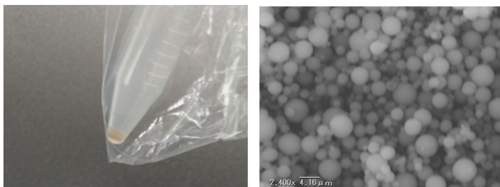
図1 生物影響実験に供給した500 kBqの不溶性粒子の模擬試料（左）と同条件で非RIで実験した時に得られた模擬粒子の電子顕微鏡像（右）
