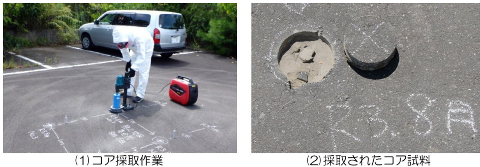
図 2 人工被覆面コア試料の採取作業と採取された試料（夏季）
