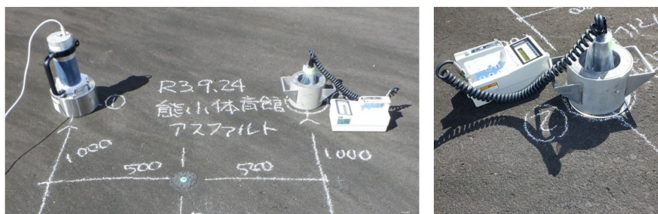
(左: シンチレーション検出器による測定、中: 樹脂遮蔽体無のGM管による測定、右: 樹脂遮蔽体有のGM管による測定)
