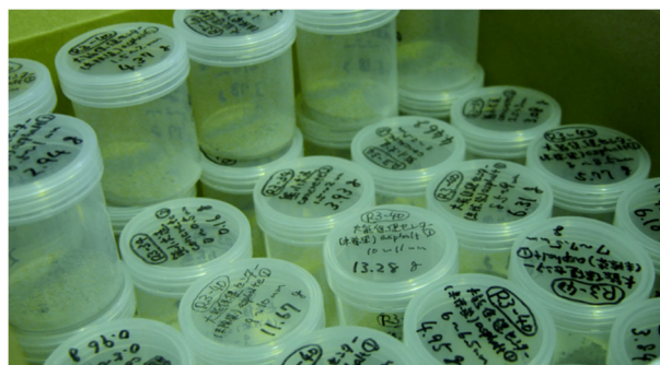
図 5 切削加工による深度毎の試料粉末
