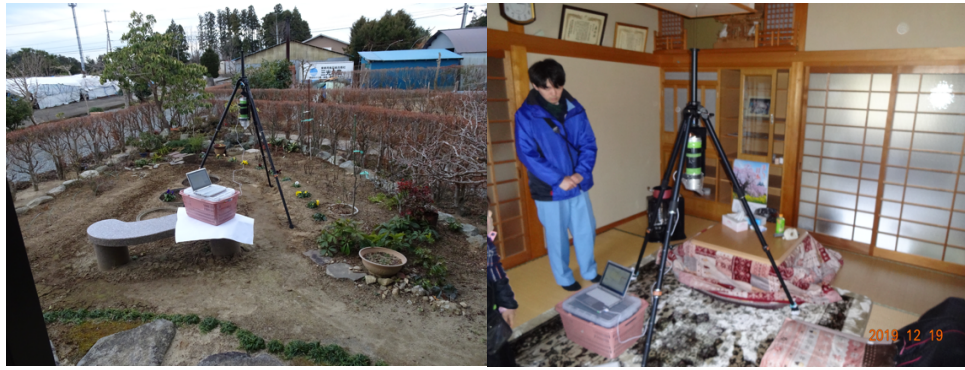
図 II-4 住家外（左図）及び住家内（右図）での \gamma 線スペクトル測定
