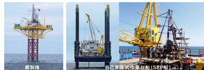
掘削・貫入試験で使用する機材例
