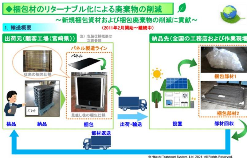
図 2.22 日立物流の梱包材のリターナブル化概要
