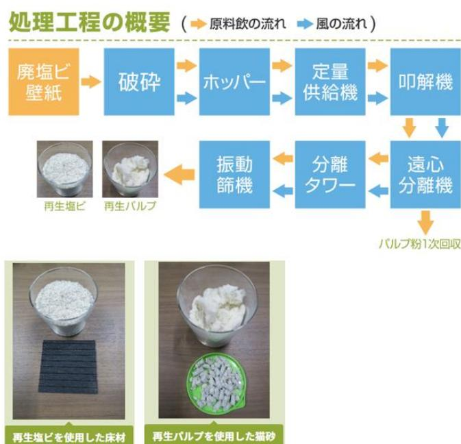
図 2.8 塩ビ系壁紙の主素材と裏打ち紙の分離技術
