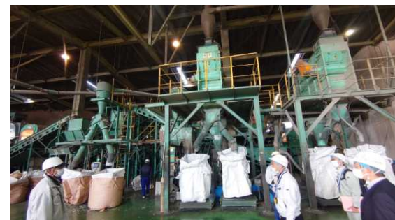
再商品化したものを フレコンへ投入する様子
