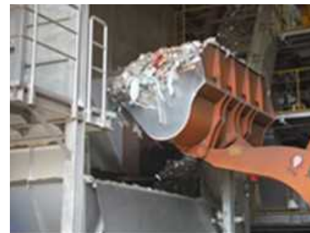
③破碎、磁選機で金属を除去後、炭化炉へ送り、熱分解ドラムで4時間回転し蒸し焼き
