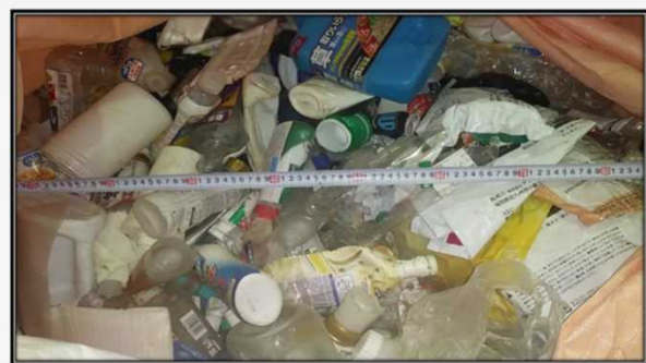
光学選別機による選別前のプラスチック
