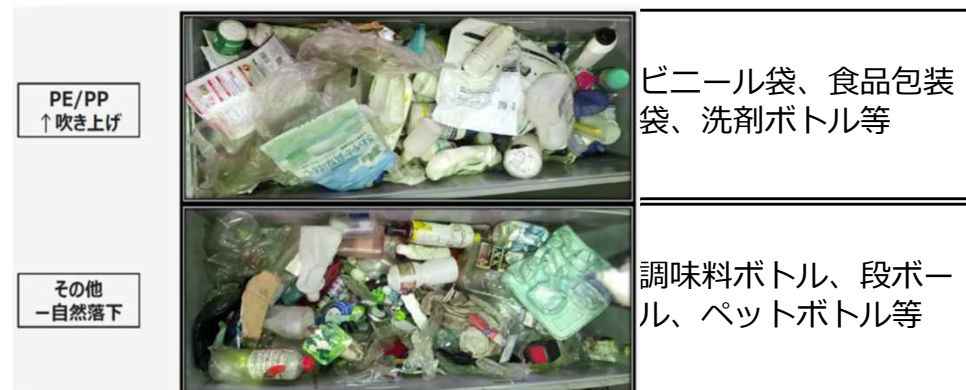
光学選別機による選別後のプラスチック
