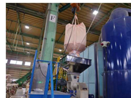
押し出し成形（ペレット化）
