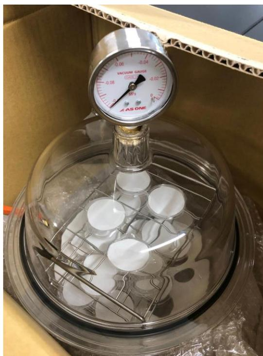
図1 真空デシケータを用いたフィルタの乾燥状況
