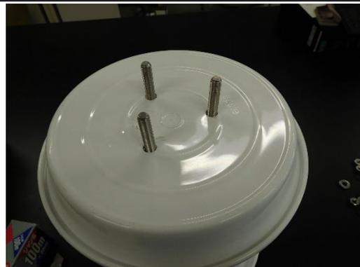
⑥ 上側の鉢皿を被せ、NBR ワッシャーと平ワッシャー、ナットで固定する
