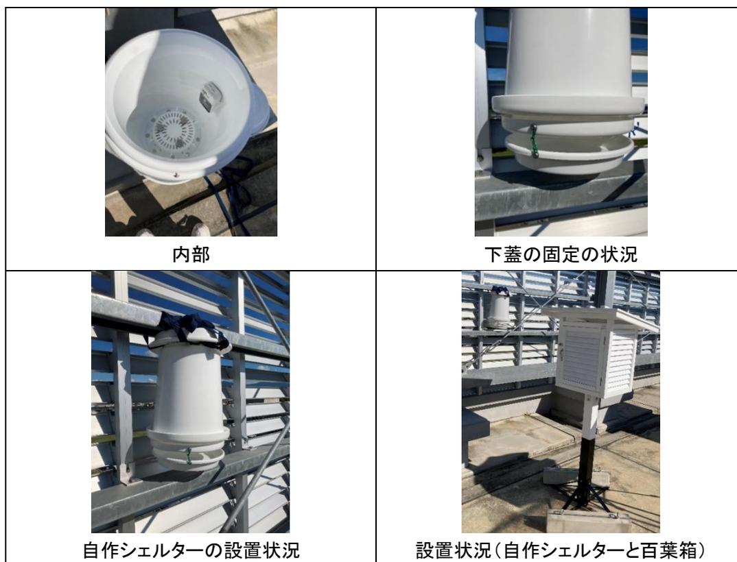
図3 温度履歴記録時の設置状況
