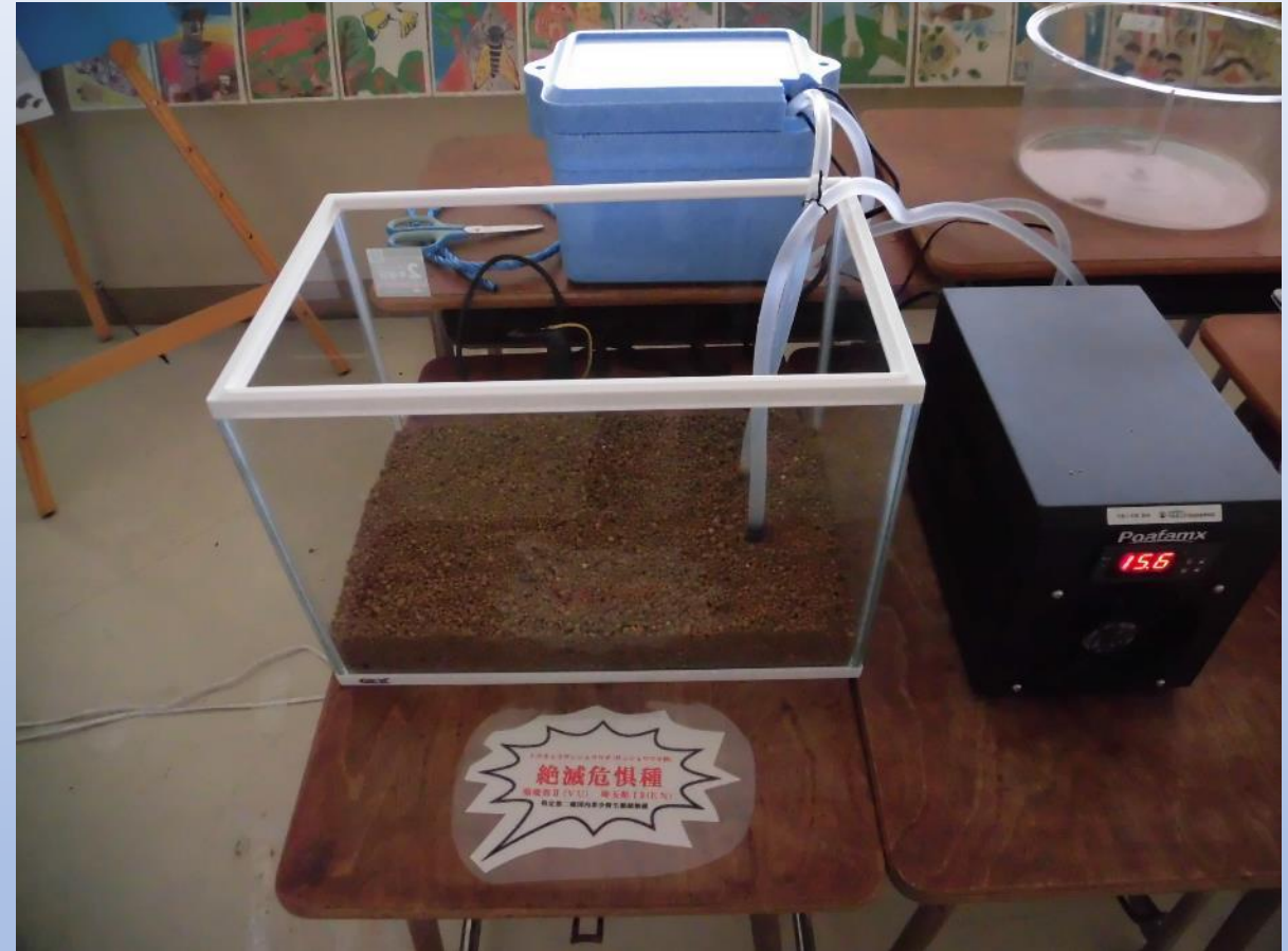
冷却装置を埋め込んだ上陸個体用水槽
