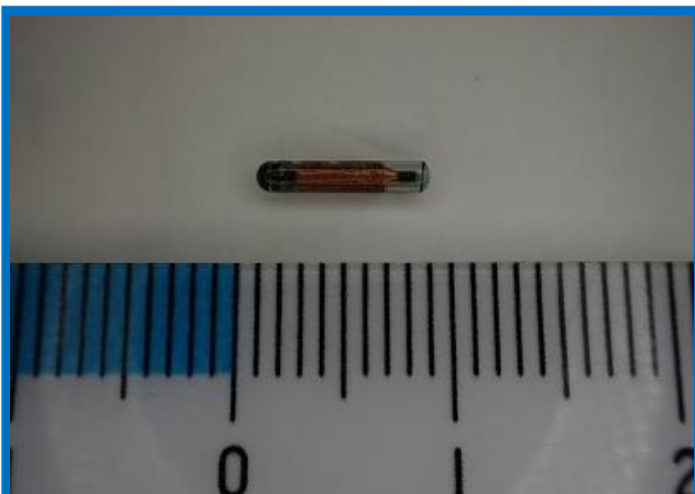
マイクロチップ 直径1.2mm・長さ8mm
