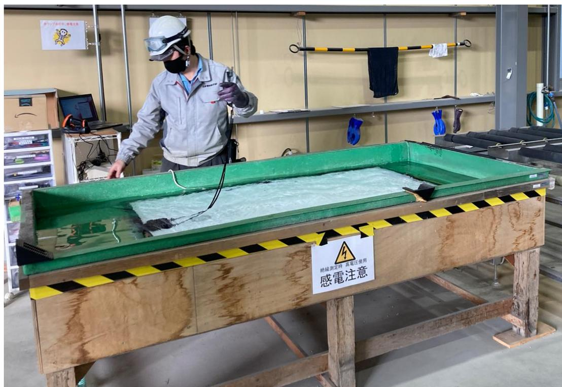
図 5-84 使用済 PV モジュールの絶縁性能 (写真左が洗浄機)
