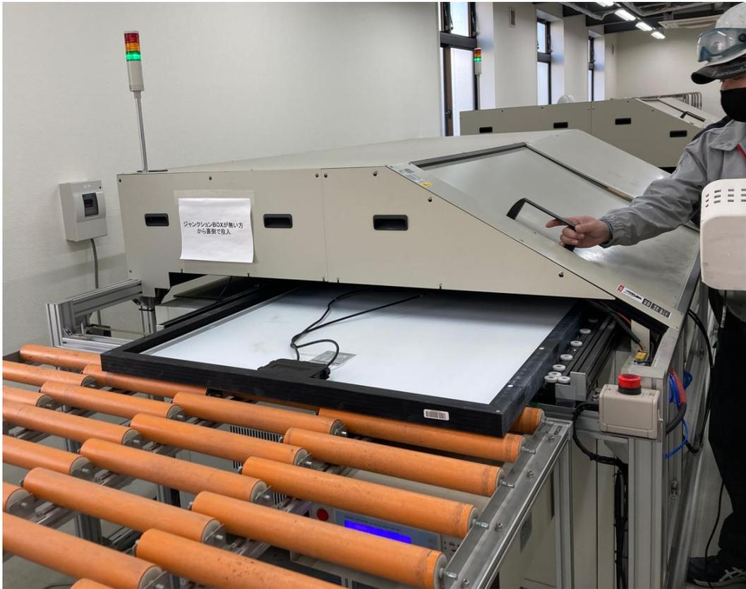
図 5-86 I-V カーブによる発電性能の検査
