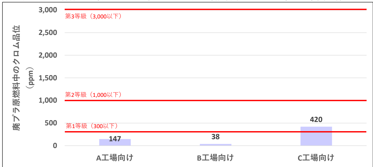
図表 71 実操業で取引されている廃プラスチック原燃料中のクロム品位と品質等級案
