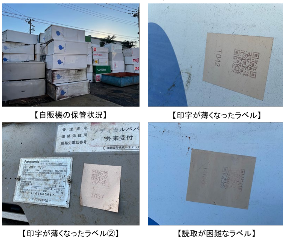
図表 15 令和3年度実証事業でのQRコードラベルの劣化状況
