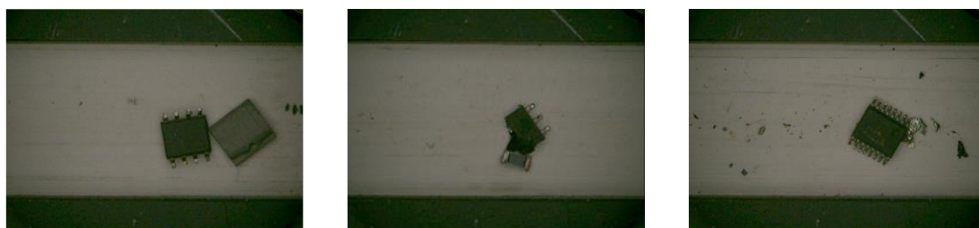
図 35 小ラインにおける誤認識状況（101IC1）
