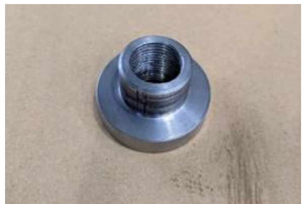
図 54 小型旋盤（左）と O2 センサー固定治具（右）
