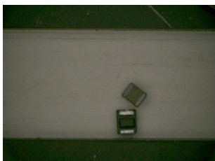
図 39 小ラインにおける誤認識状況（603 水晶発振子）
