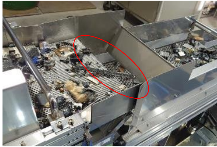
図 30 篩装置の長物部品のブリッジ
