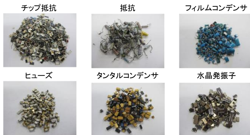
図 4 蒸気分離後の電子部品
