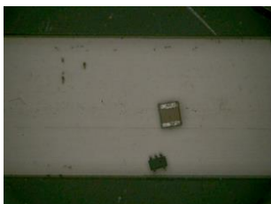
図 41 小ラインにおける誤認識状況（703 セラミックコンデンサ 3）
