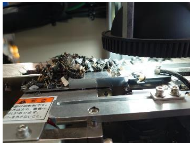
図 31 コンベア上の部品詰まり
