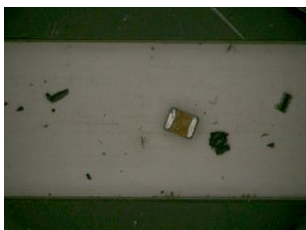
図 40 小ラインにおける誤認識状況（702 セラミックコンデンサ 2）
