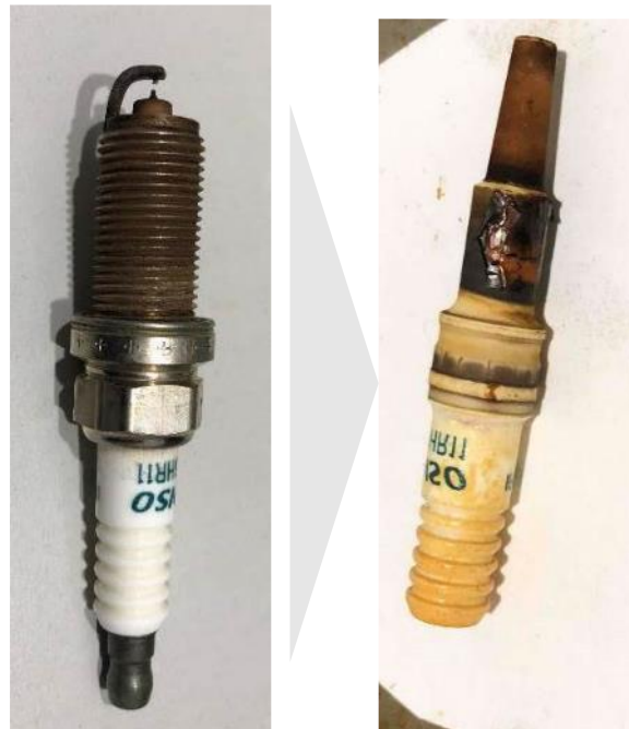
図 68 着火プラグの溶解前後比較
