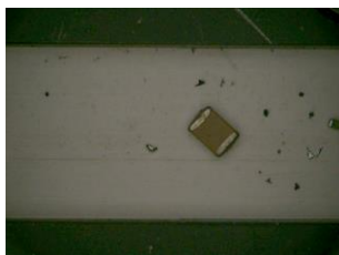
図 39 小ラインにおける誤認識状況（603 水晶発振子）
