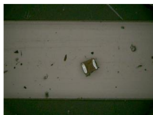
図 40 小ラインにおける誤認識状況（702 セラミックコンデンサ 2）
