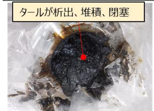
図 4-2-4 ガス精製装置 対策前後でのタール析出状況の比較
