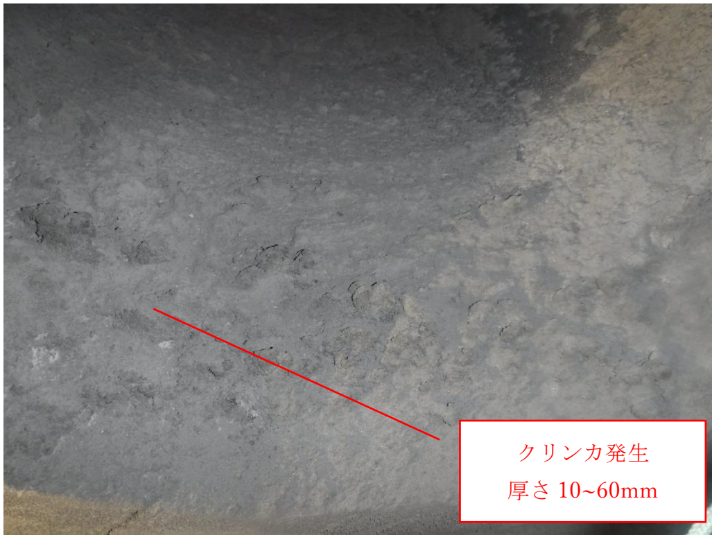
図 5-2-12 冷却/燃焼空気量調整後のクリンカ付着状況(付着が激しい箇所)
