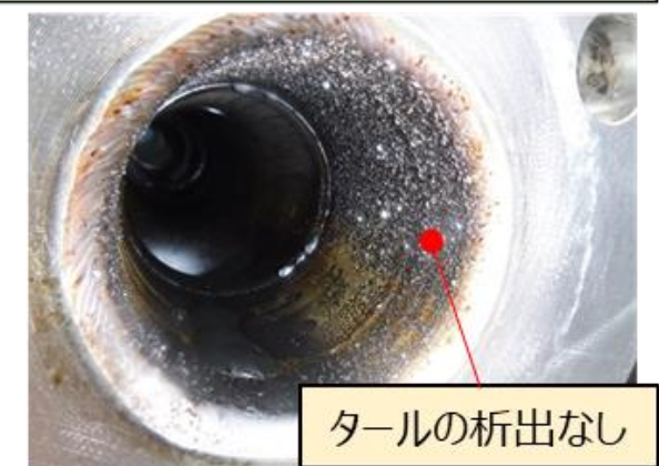
図 4-2-4 ガス精製装置 対策前後でのタール析出状況の比較
