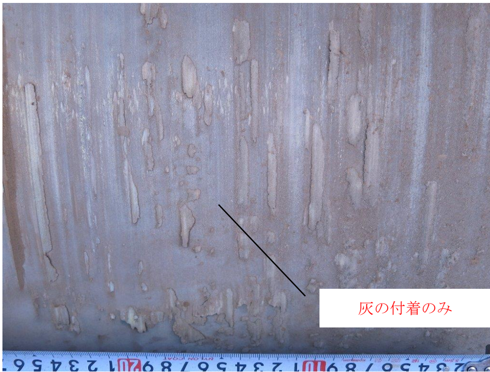
図 3-2-12 (a)改質部でのキルン外面の写真
