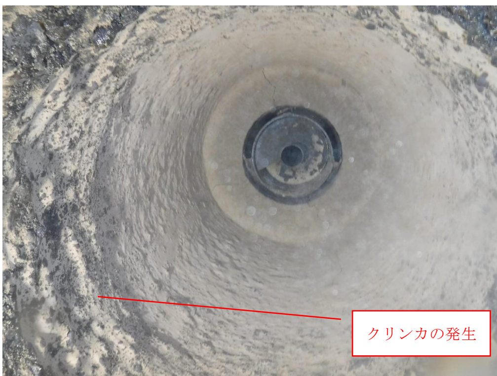
図 5-2-8 チャー混焼開始後のクリンカ付着状況
