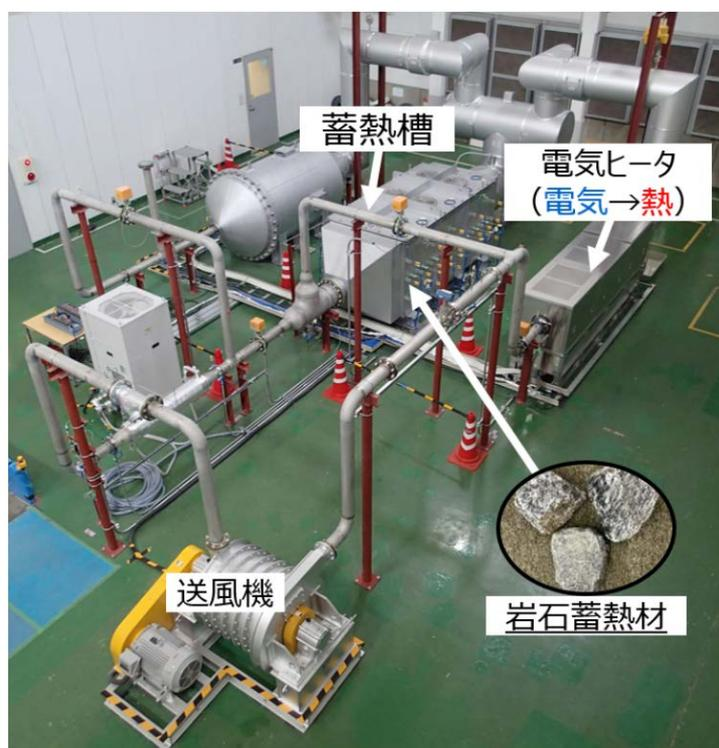
図5-11 岩石蓄熱実証実験設備
