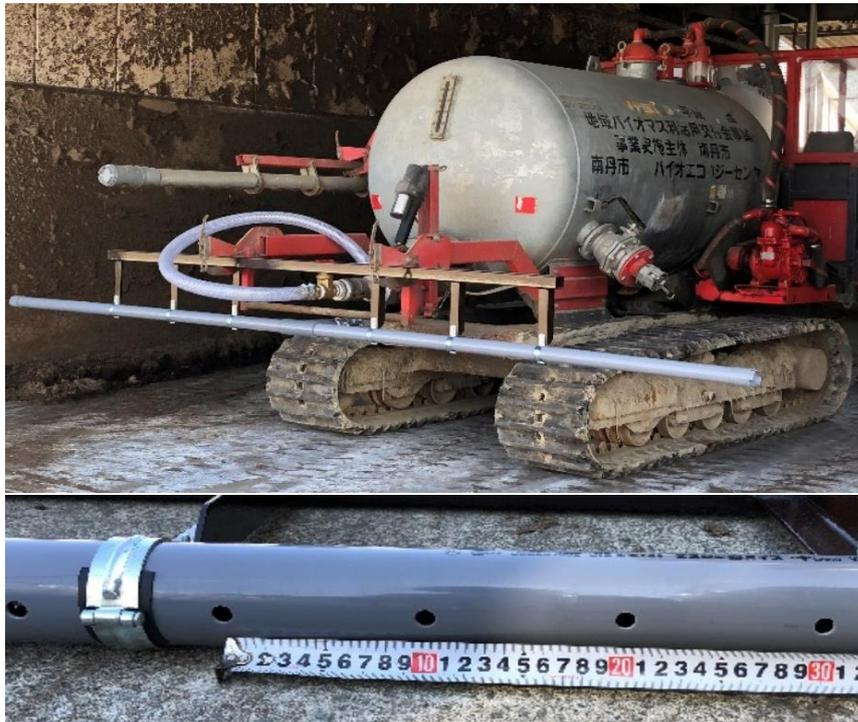
図 3 1 本事業で作成したの散布部の形状
