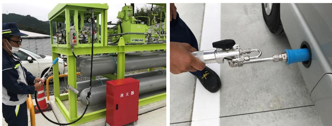
図 2-10 充填ノズル（左）、充填の様子（右）
