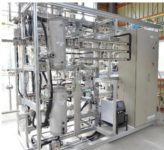
図 2-3 ハイブリッド精製装置
