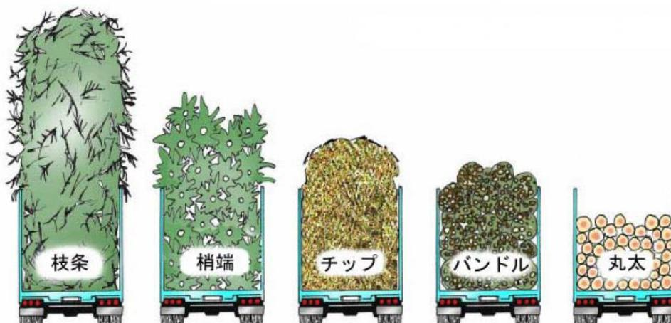
図 2-18 森林系バイオマス資源の輸送に係るイメージ図<sup>[2-8]</sup>
