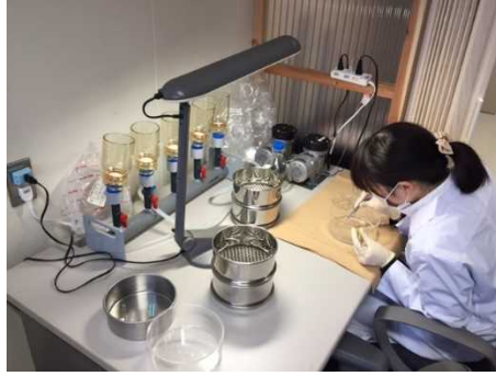
写真Ⅲ-2 マイクロプラスチックの手作業による分別
