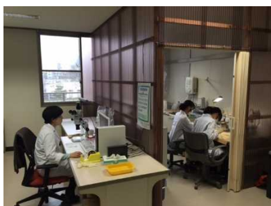
写真Ⅲ-6 分析室。ホルマリンを含む海水処理のため、安全を考慮して換気を強化した別室で行った。
