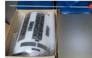
図-4 本研究で用いた漂流ブイ スケールは1mを示す
