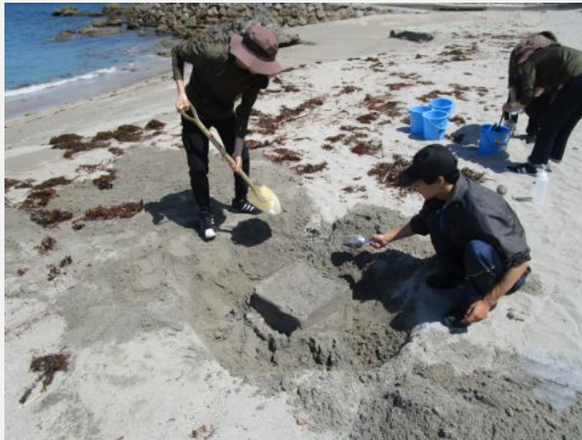
正方形の柱を残して砂を掘る
