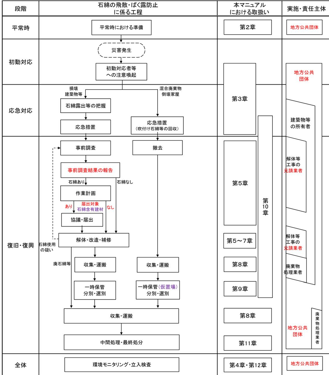
図 12.1 災害時における石綿の飛散・ばく露防止に係る工程（再掲）
