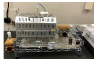
燃烧による I-129の分離精製
