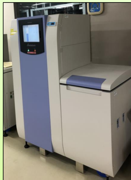
○液体シンチレーションカウンタ
