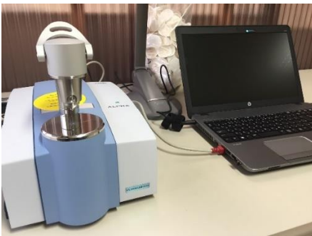
写真Ⅲ-3 材質判定に用いた FT-IR
