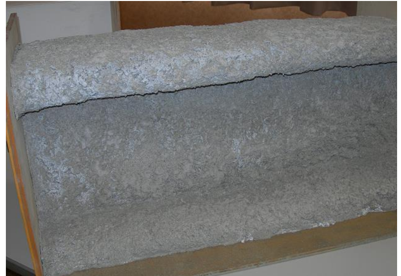
吹付けロックウール(無石綿) のカットモデル
