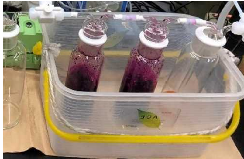
写真 30L/分で100分吸引した場合の液はねの状況
