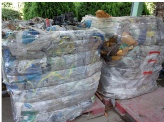
図 4.8 選別後の塩素濃度が低い建設系廃プラスチック（サーマルリサイクル）
