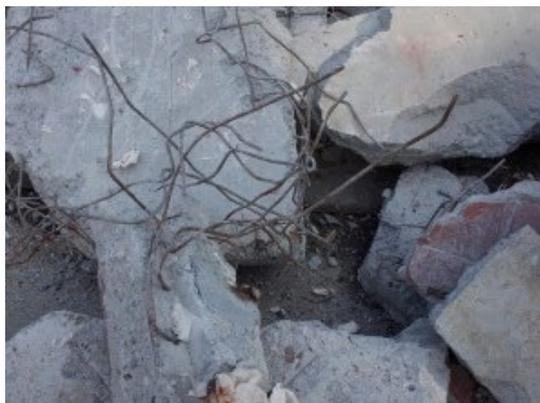
図 3.1 鉄筋、タイルの混入
