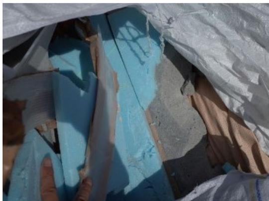
図 4.5 複合建材（モルタルが付着した断熱材）
