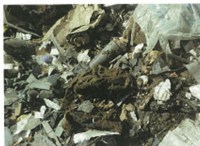
アスファルト防水シート混入物
