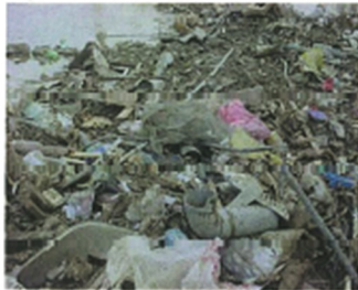
解体後残渣（解体ミンチ） ・ 重機等でミンチ解体を行ったもの ・ 壁土、屋根土など
