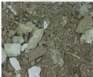
新築時掃き出しゴミ ・ 新りガラ、石膏ボード粉、木粉など
