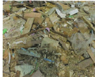
おが粉等の混入物 ・ 微細物が多く混入されているもの
