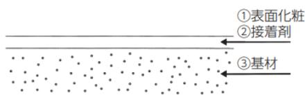
図 3.6.1 複合素材を混合した建材 繊維強化スレート板（繊維混入けい酸カルシウム板）
