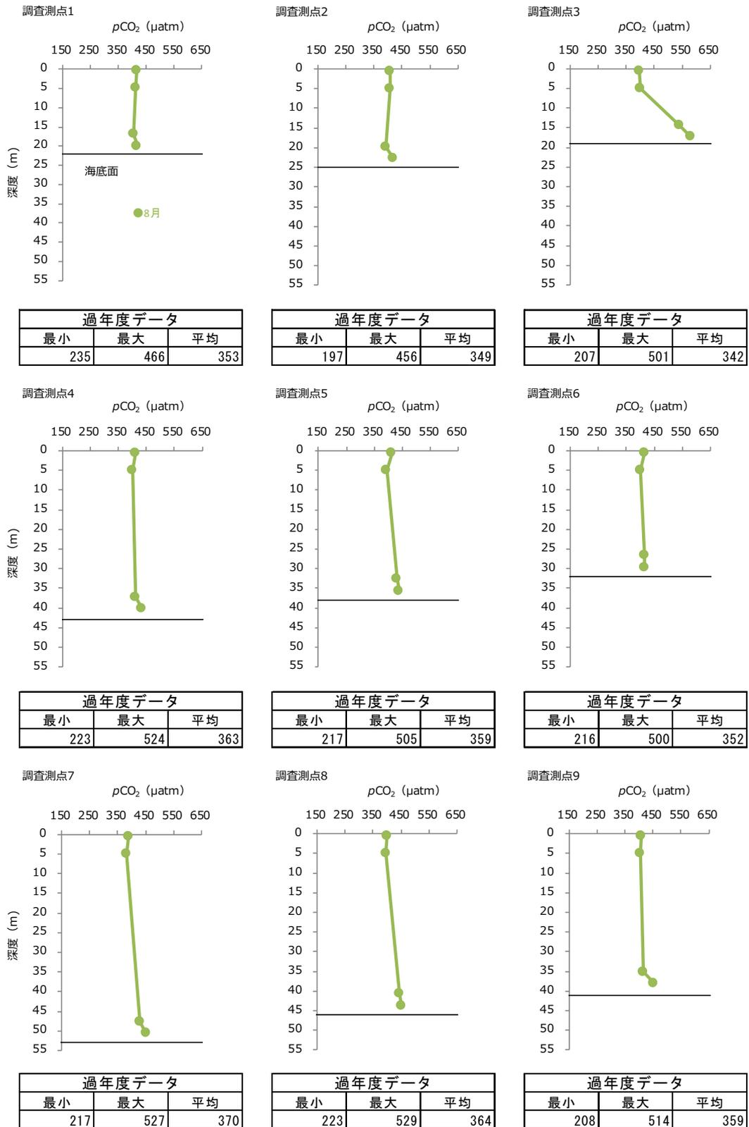
図-14 2023年度夏季 各調査測点における二酸化炭素分圧 ( $p\text{CO}_2$ ) の鉛直プロファイル
