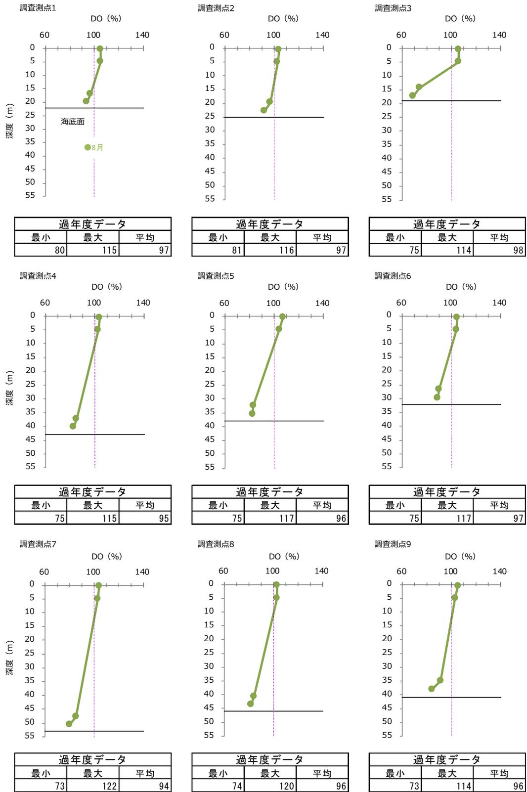
図-16 2023 年度夏季 各調査測点における溶存酸素 (DO) 飽和度の鉛直プロファイル
