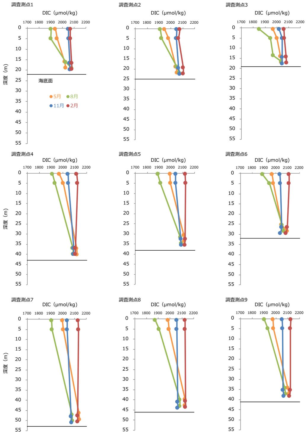
図-9 2022年度 各調査測点における全炭酸 (DIC) 濃度の鉛直プロファイル
