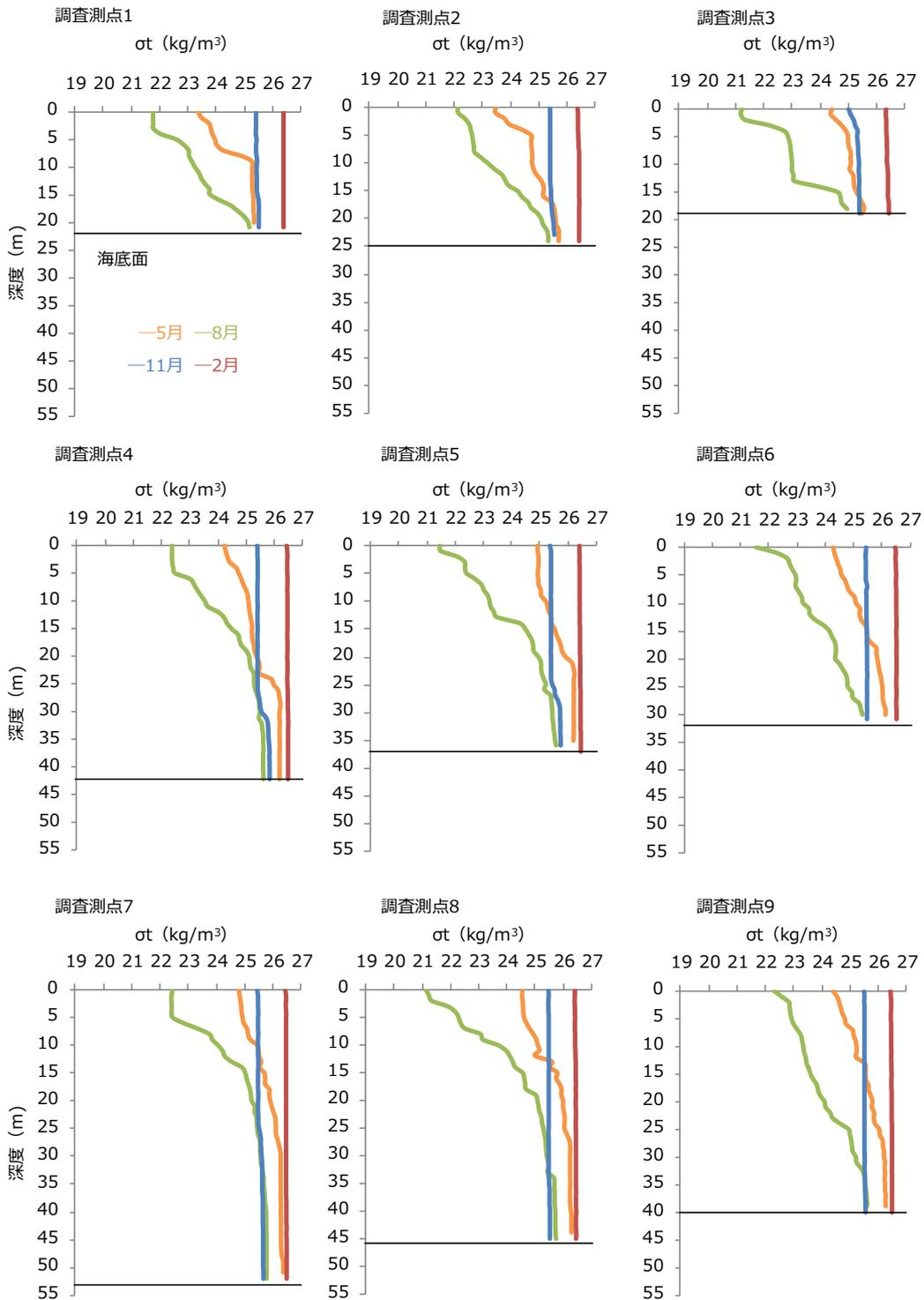
図-5 2022年度 各調査測点における海水密度 ( $\sigma_t$ ) の鉛直プロファイル
