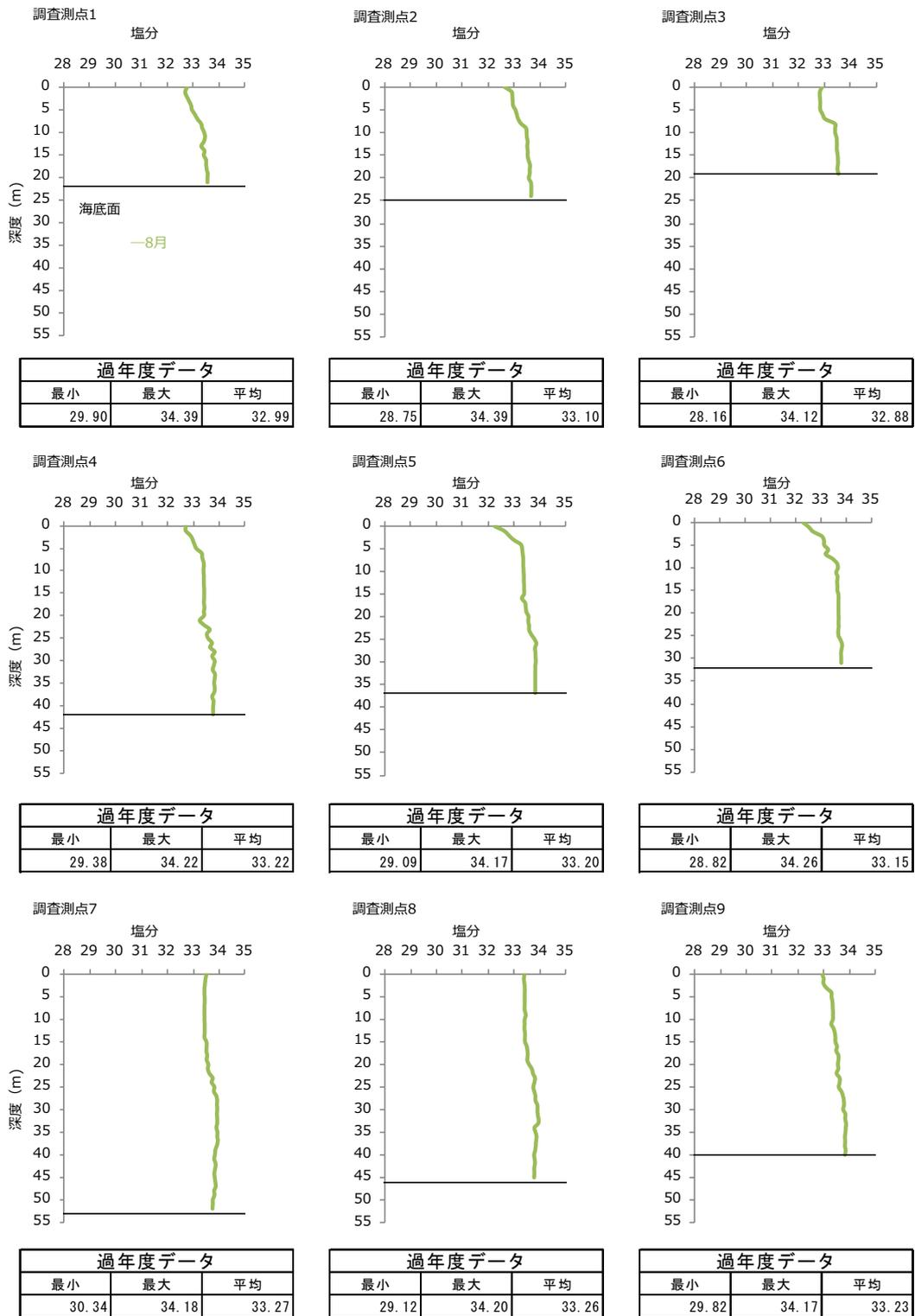
図-4 2023年度夏季 各調査測点における塩分の鉛直プロファイル
