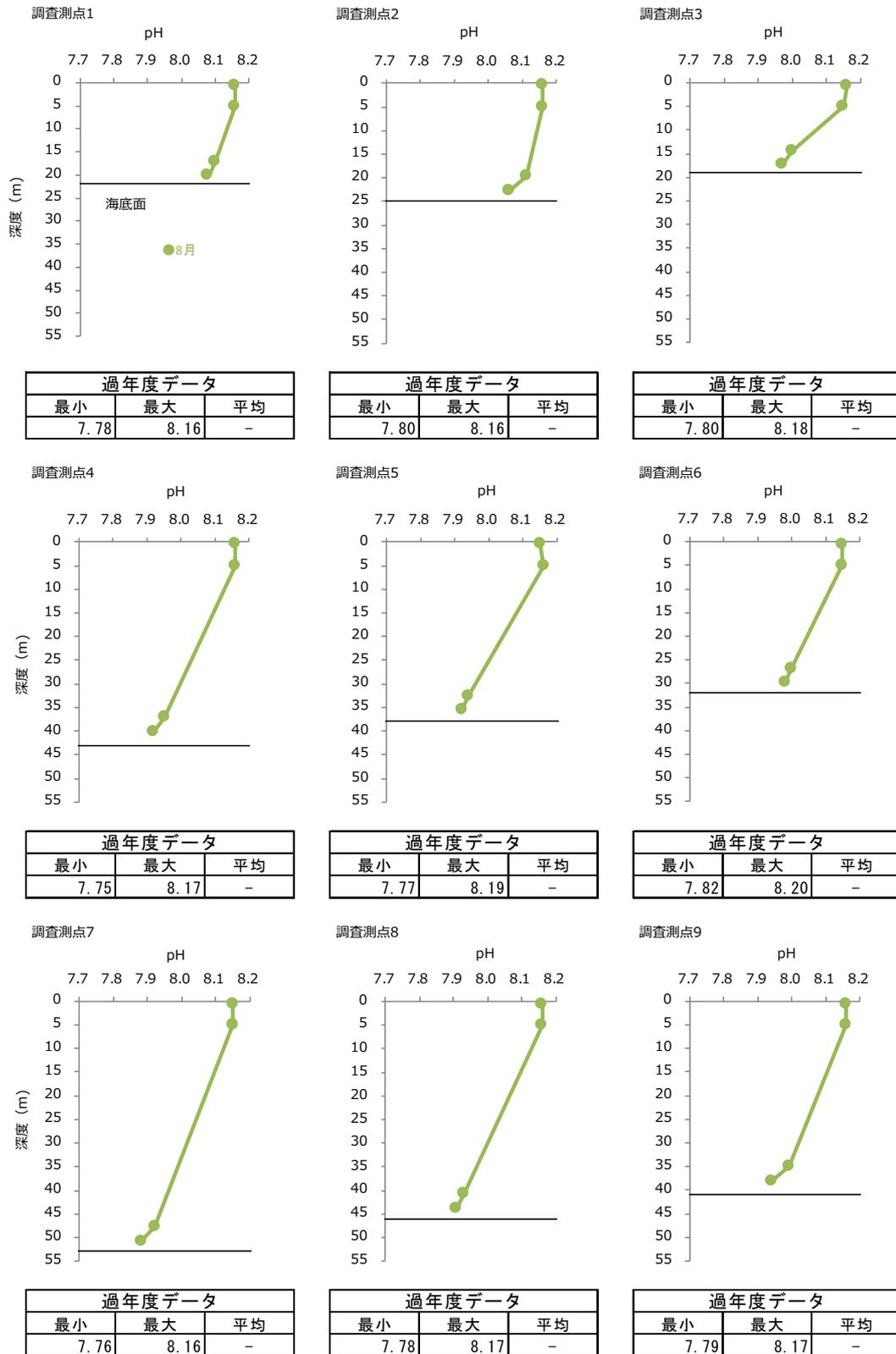
図-12 2023年度夏季 各調査測点における pH の鉛直プロファイル
