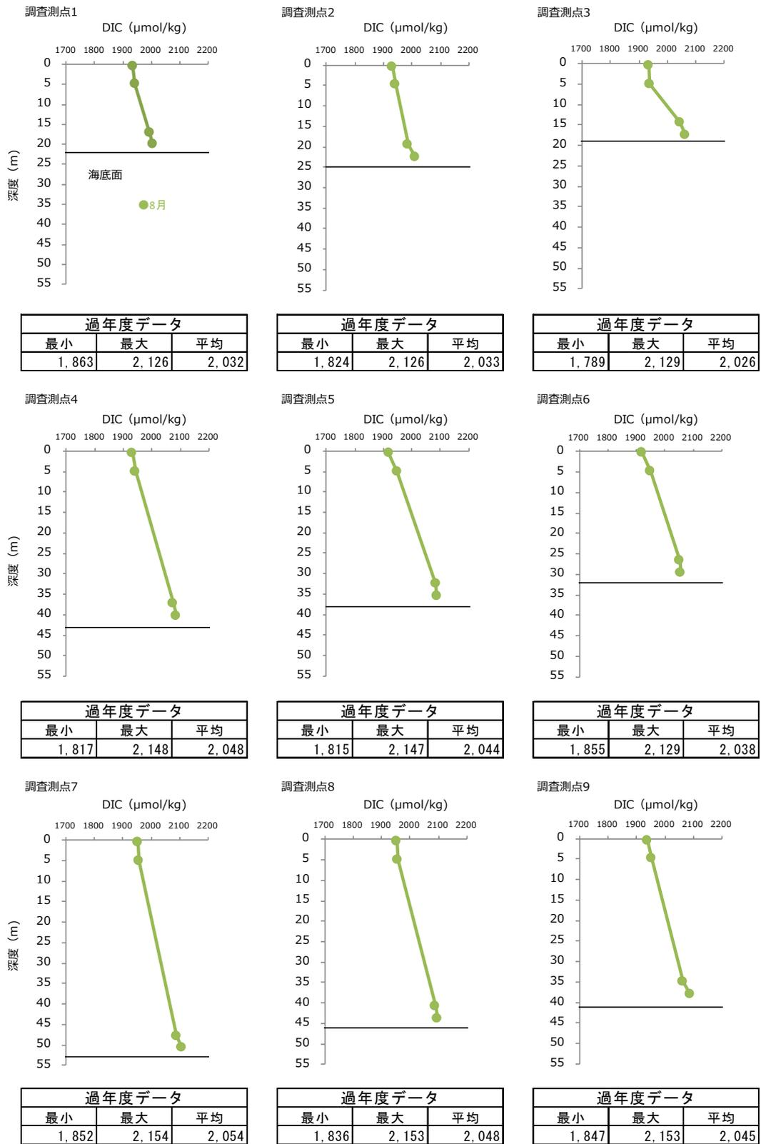
図-10 2023年度夏季 各調査測点における全炭酸 (DIC) 濃度の鉛直プロファイル
