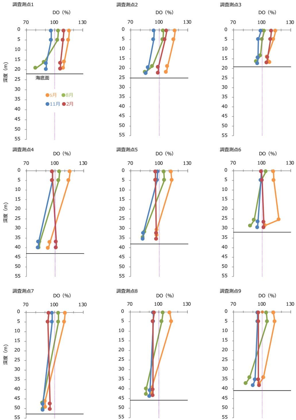
図-15 2022年度 各調査測点における溶存酸素 (DO) 飽和度の鉛直プロファイル
