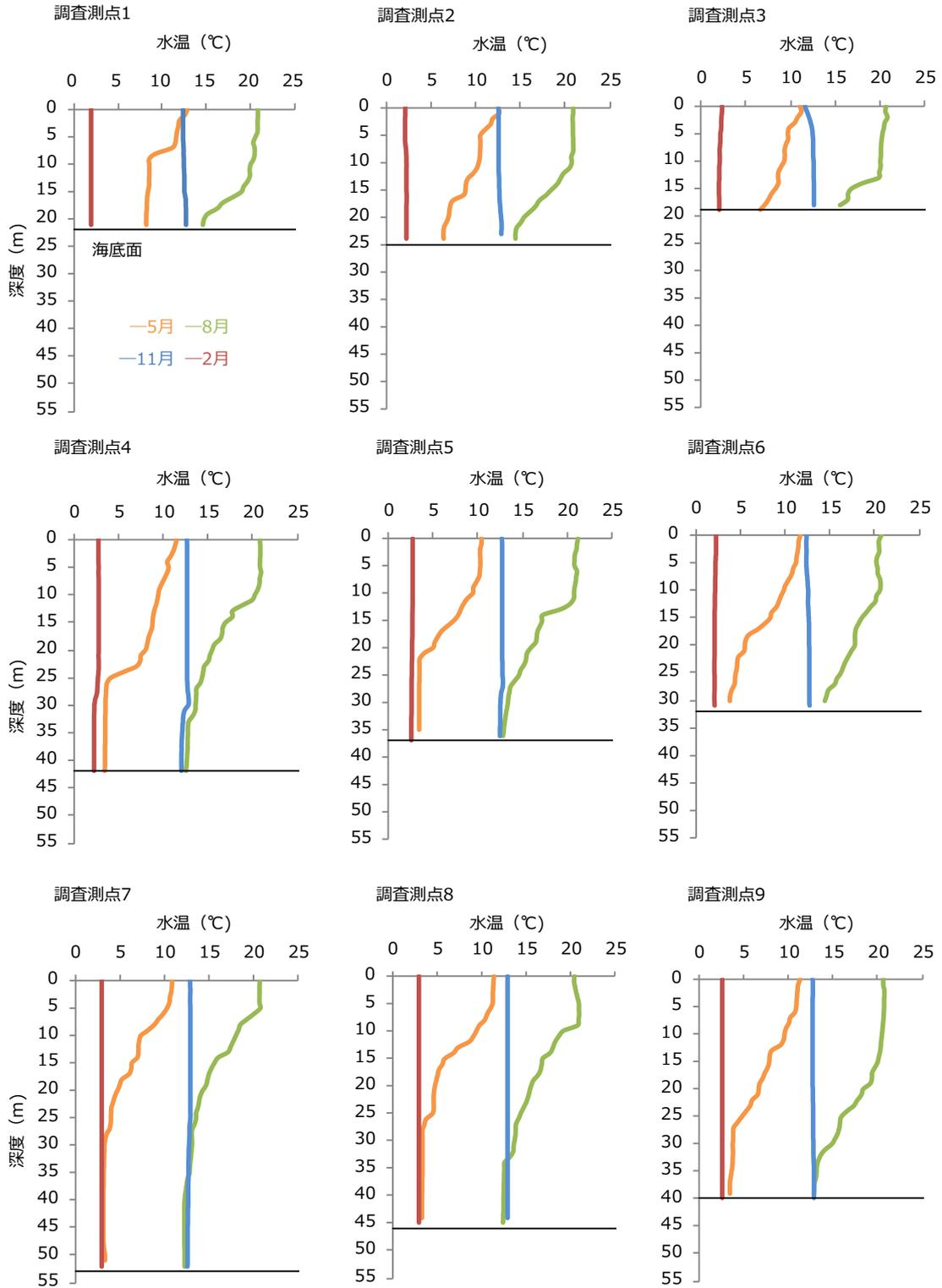
図-1 2022年度 各調査測点における水温の鉛直プロファイル
