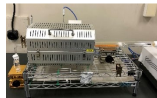
燃焼による I-129の分離精製
