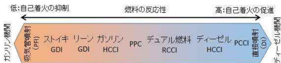
図 2.5-3 燃料の反応性をもとにした種々の着火方式のコンセプト（文献 204 より作成）
