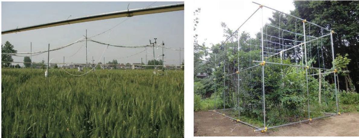
7 8 図 5 FACE 型のオゾン曝露システム. 左: 作物を対象としたシステム 9 (中国江蘇省) (Kobayashi, 2015). 右: 樹木を対象としたシステム 10 (北海道大学, 北海道札幌市). 11
