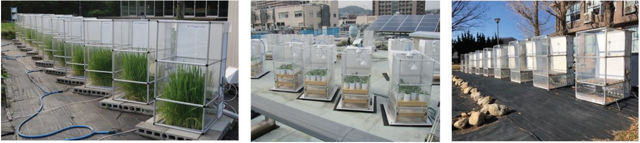
図 3 日本で利用されている小型のオープントップチャンバー (OTC) の一部。左: 埼玉県環境科学国際センター (埼玉県加須市), 中央: 長崎大学 (長崎県長崎市), 右: 山梨大学 (山梨県甲府市). Heagle et al. (1973) が開発した OTC は円形の筒型でより大型である。
