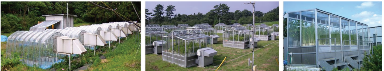
図 4 グリーンハウス型のフィールドチャンバー (東京農工大学, 東京都八王子市) (左) とガラス温室型のオープントップチャンバー (中央: 電力中央研究所, 群馬県前橋市; 右: 埼玉県環境科学国際センター, 埼玉県加須市)
